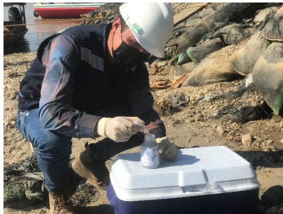
Figura 28 Colocación de reactivo (ácido sulfúrico) para muestreo de la DQO
