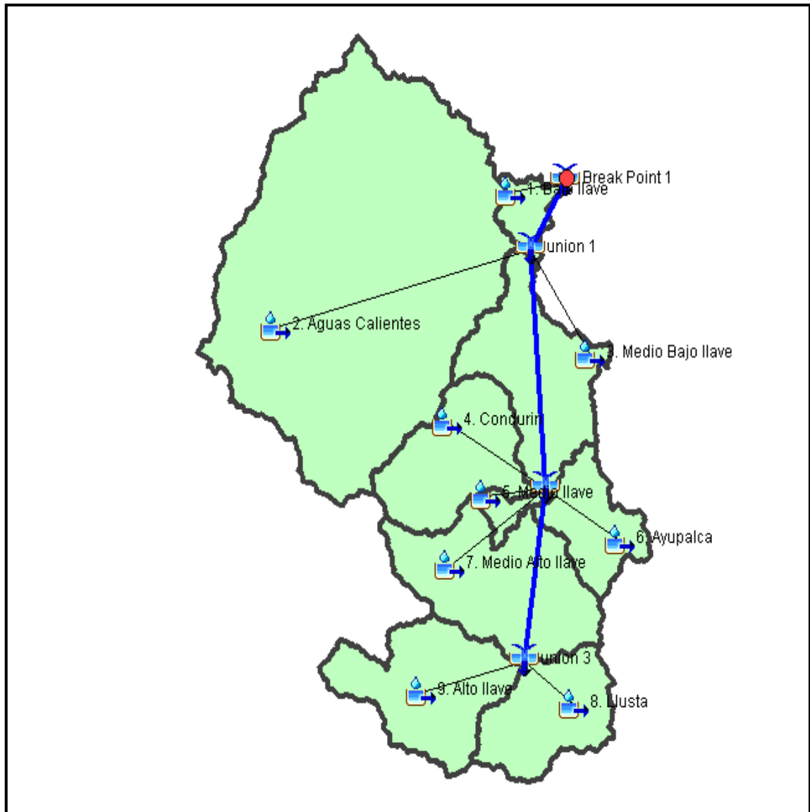
Figura 23. Esquema de los elementos hidrológicos conectados – modelo de cuenca Ilave.
