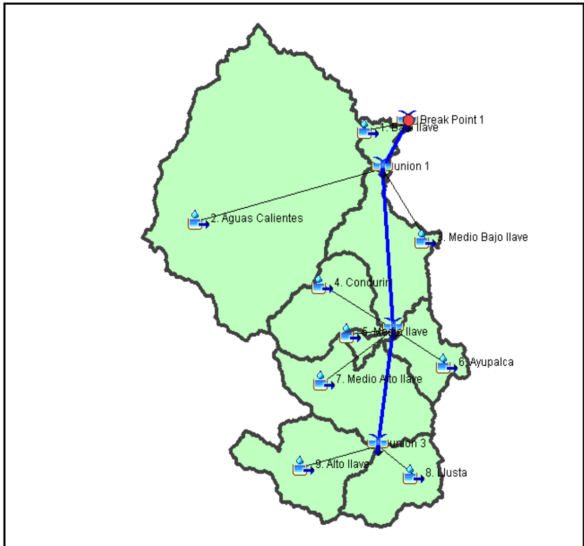
Figura 27. Esquema de los elementos hidrológicos conectados – modelo de cuenca.
