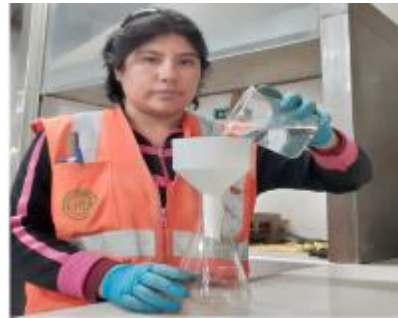
Figura 3. 12 Filtración para eliminar solidos suspendidos
