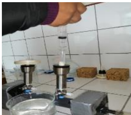
Acondicionamiento de cartuchos
