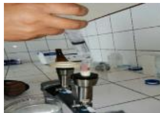
Figura 3. 15 Acondicionamiento de los Cartuchos con Metanol HPLC y Agua Ultrapura
