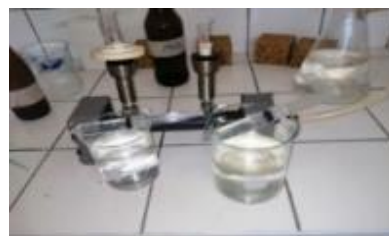
Figura 3. 16 Extracción Solido Liquido en Cartucho SPE. Extracción al Vacío
