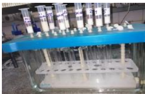
Figura 3. 22 Equipo para el lavado de cartuchos con hormonas
