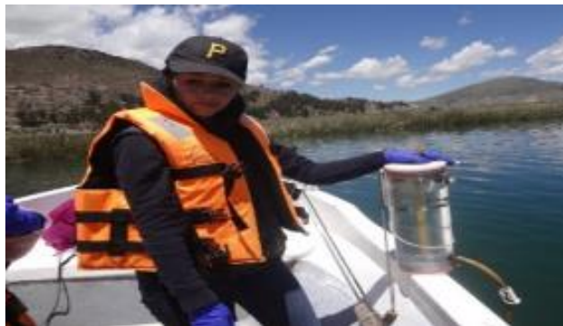
Figura 3. 8 Muestreador Vertical de Teflon Niskym de 5L.
