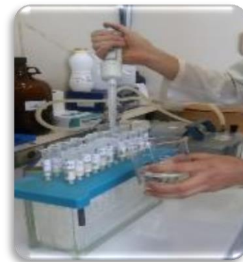
Manifold Supelco Visiprep, para elusion de hormonas
