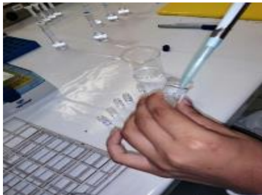
Figura 3. 24 Secado de solución eluida con flujo de N 2 a 30°C
