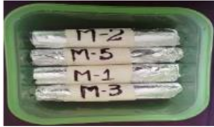
Figura 3. 17 Embalaje de los Cartuchos (SPE) para traslado (4°C)
