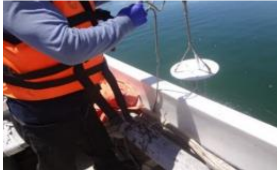
Figura 3. 7 Medidor de turbidez disco SECCHI
