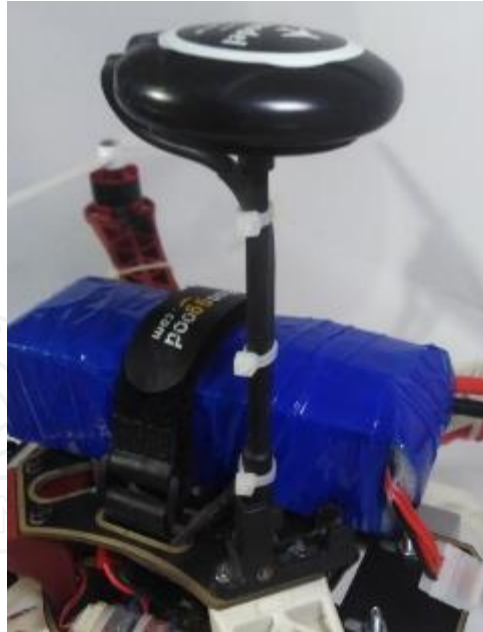
Figura 43. Montaje e instalación de GPS
