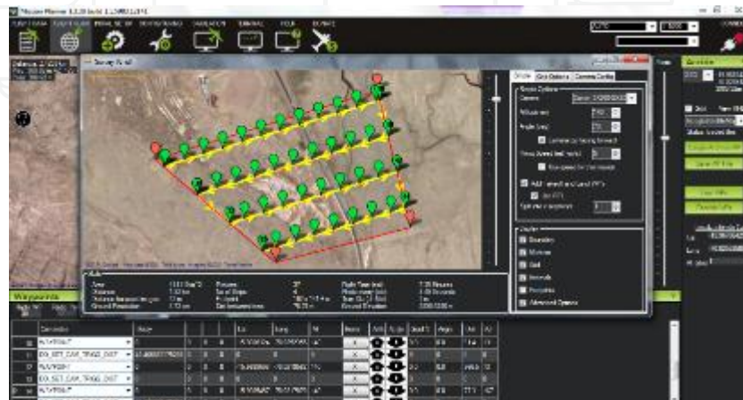
Figura 71. Programación de traslapes y altura de vuelo
