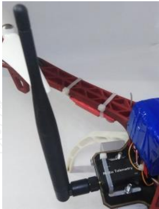
Figura 42. Montaje y conexión del módulo de telemetría.
