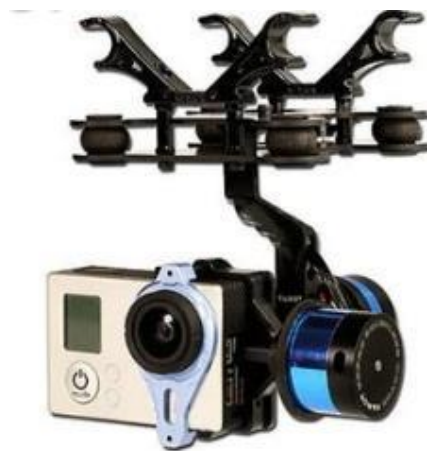
Figura 25. Gimbal tarot 2D armado, con cámara
