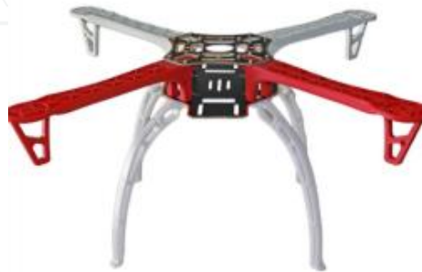
Figura 10. Tren de aterrizaje ensamblado en chasis
