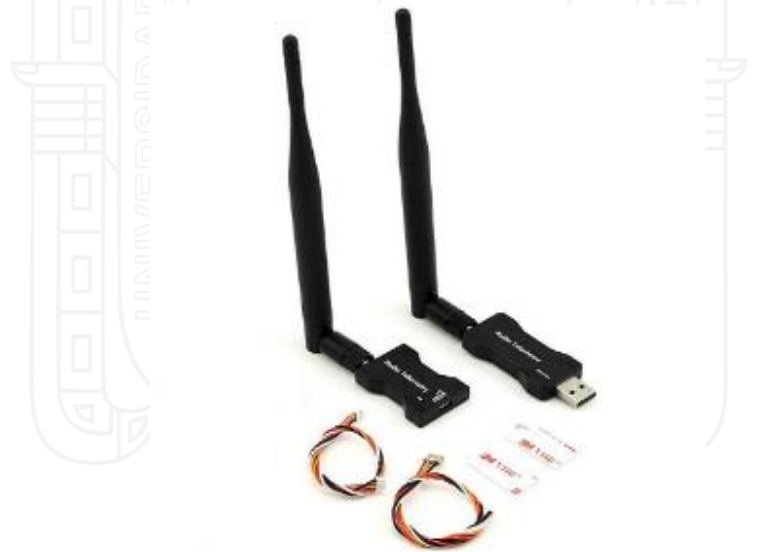
Figura 17. Módulo de telemetría 3DR de 500MW
