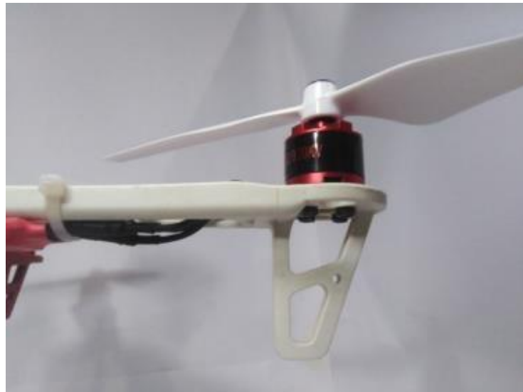
Figura 36. Montado de motores Brushless en chasis DJI F450
