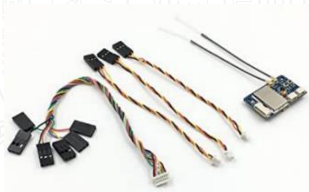
Figura 15. Conectores PIN, I-BUS y PPM con placa receptor.
