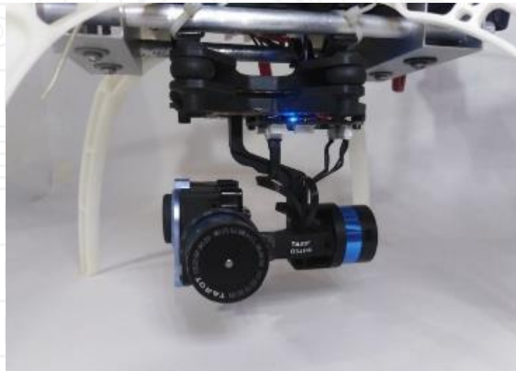
Figura 44. Montaje e instalación de gimbal y cámara
