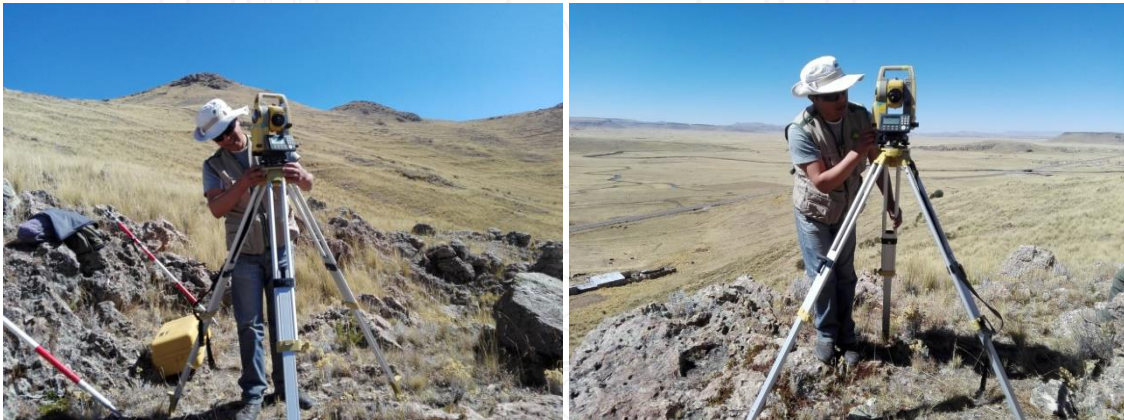
Figura 83. Levantamiento topográfico con estación total
