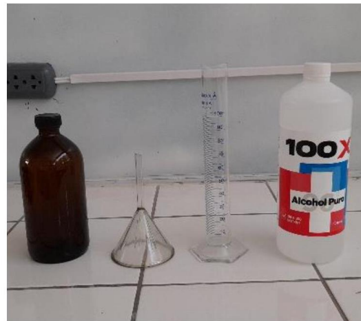
SE UTILIZO POMO AMBAR, EMBUDO DE VIDRIO, PROBETA DE VIDRIO Y ALCOHOL AL 96%
