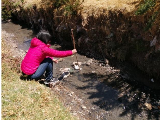
Fotografía 15. Medida del caudal por el metodo del corcho según chamorro para la determinación de la carga contaminante de los parametros fisicoquímicos y bacteriológicos que ingresan a la laguna confinada desde los afluentes.
