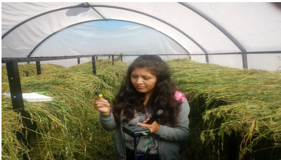
Figura 23 A9. Registro de T°C y HR% con higrómetro dentro del secadores
