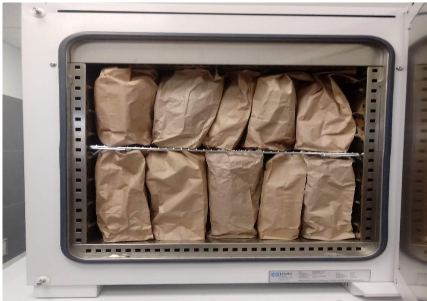
Figura 27 A13. Muestras en estufa eléctrica a 60 °C por 48 horas
