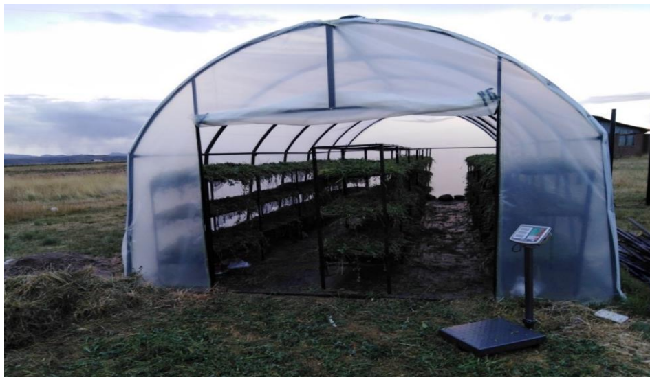
Figura 19 A5. colocación de forraje en modulo secador solar tipo túnel
