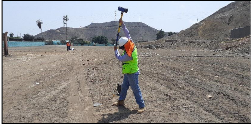
FIGURA 19: Obtención de Fuente Sísmica con golpes de Martillo de 10 Libras.
