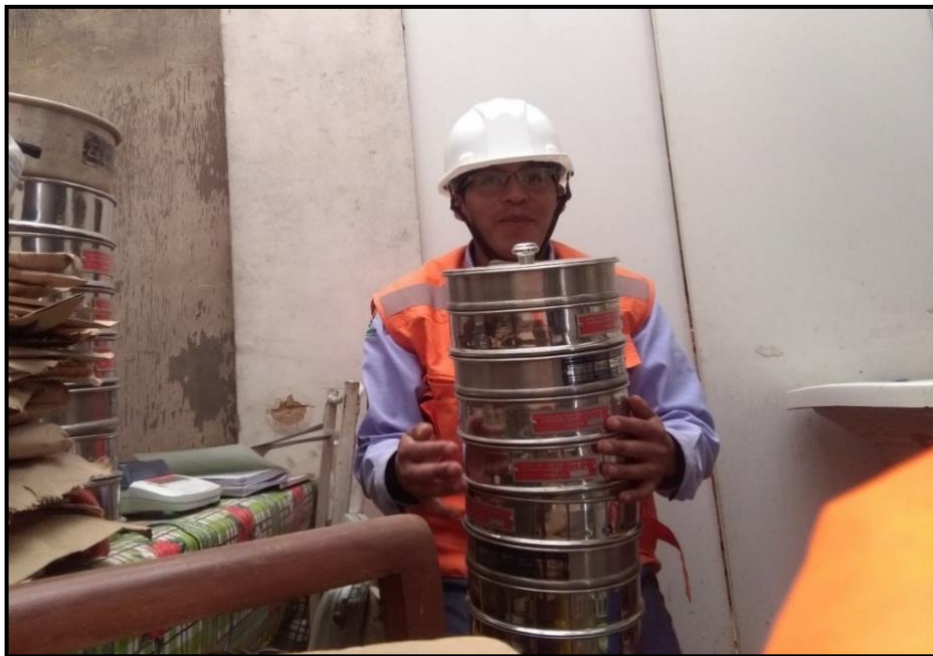
FIGURA 26: Ensayo en laboratorio análisis granulométrico.
