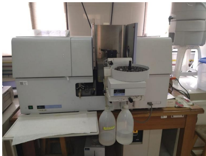
Figura 16. Equipo de análisis de metales del laboratorio de calidad ambiental de la Universidad Mayor de San Andrés Bolivia.
