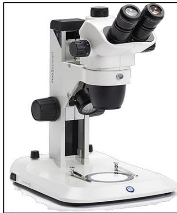
**Figura Nro. 4:** Modelo de microscopio EUROMEX acromático.
