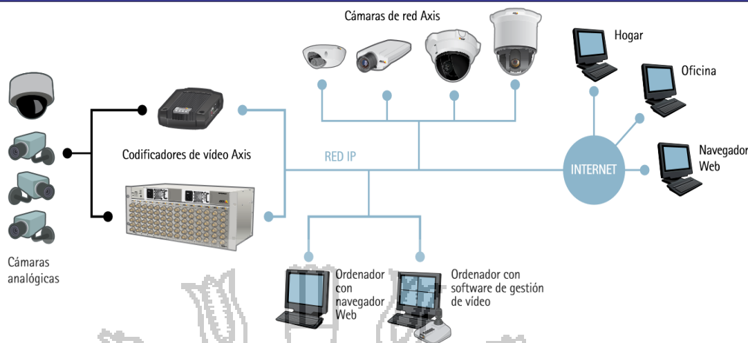
Figura 2. 13: Componentes Básicos d un sistema de video en red.
