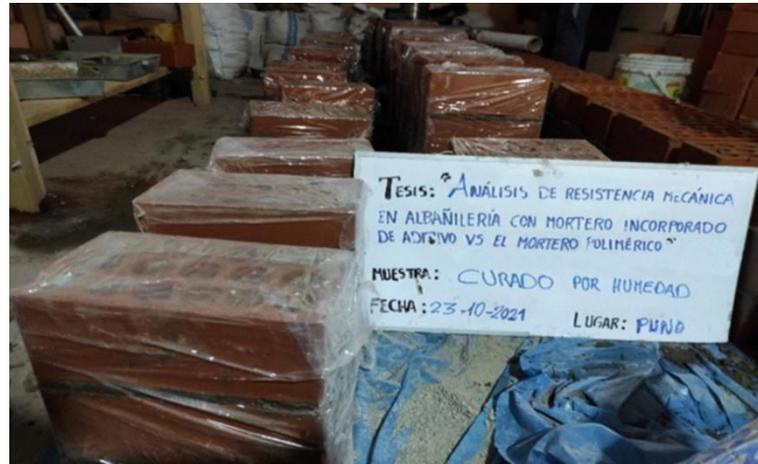
*Nota.* Después de las primeras 48h de curado de las pilas construidas, se mantuvo cubierto en bolsas de plástico hasta los dos días antes del ensayo. Fuente: Elaborado por el equipo de trabajo.
