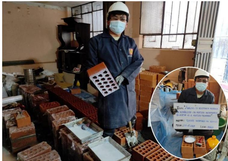
*Nota.* Proceso de elaboración de pilas de ladrillo con mortero incorporado con aditivo SikaLatex®. Donde en ambas superficies de contacto con el mortero se colocó en forma de lechada. Fuente: Elaborado por el equipo de trabajo.
