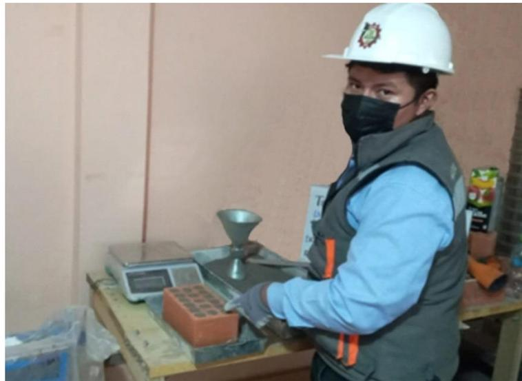
*Nota.* Se niveló la arena de las perforaciones con la parte superior del ladrillo. Fuente:
