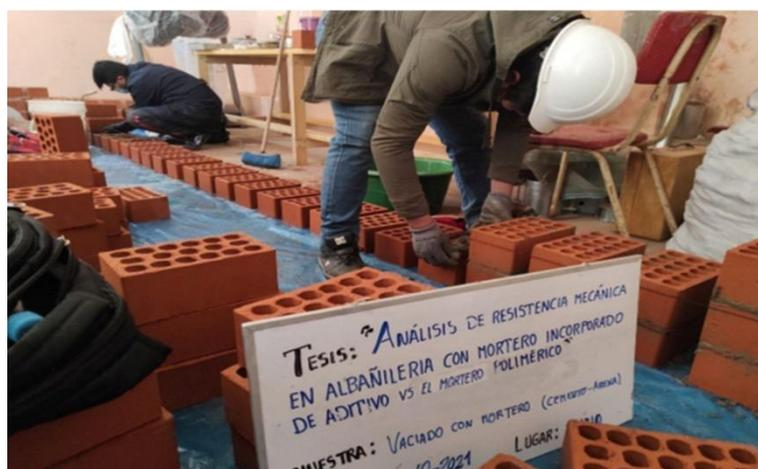
*Nota.* Elaboración de pilas de ladrillo con mortero convencional (cemento – arena) muestra patrón. Fuente: Elaborado por el equipo de trabajo.
