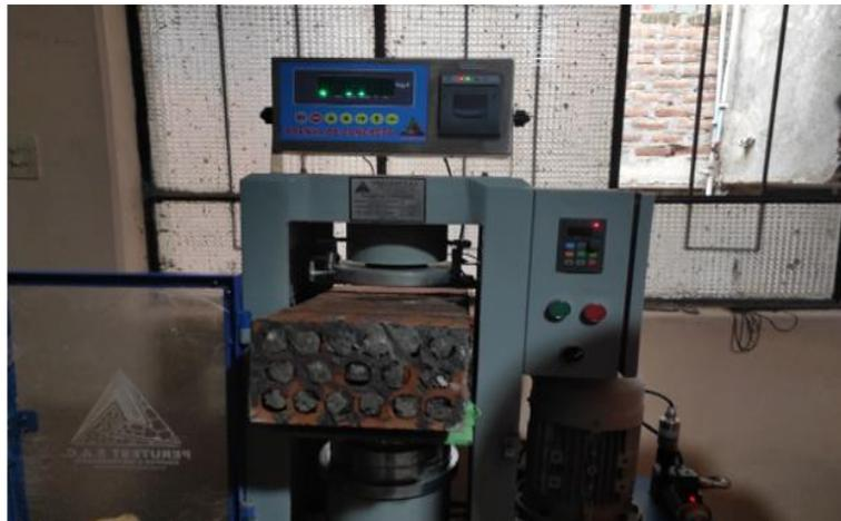
*Nota.* Ensayo a la flexión en pilas de ladrillos de cuatro unidades, elaborados con mortero convencional (cemento – arena). Fuente: Elaborado por el equipo de trabajo.
