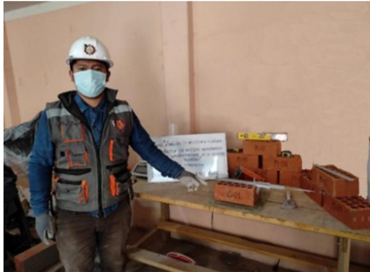
*Nota.* Medición con el vernier los lados del ladrillo. Fuente: Elaborado por el equipo de trabajo.
