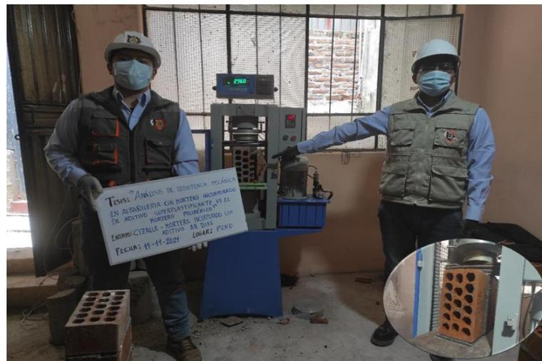
*Nota.* Ensayo de adherencia por cizalle elaborados con 03 unidades de ladrillo y con mortero incorporado con aditivo SikaLatex®. Fuente: Elaborado por el equipo de trabajo.
