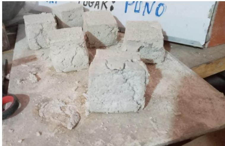
*Nota.* Perdió la geometría los cubos con Massa DunDun y el secado se dio más de un mes, por lo que no se ensayaron dichos cubos de mortero. Fuente: Elaborado por el equipo de trabajo.
