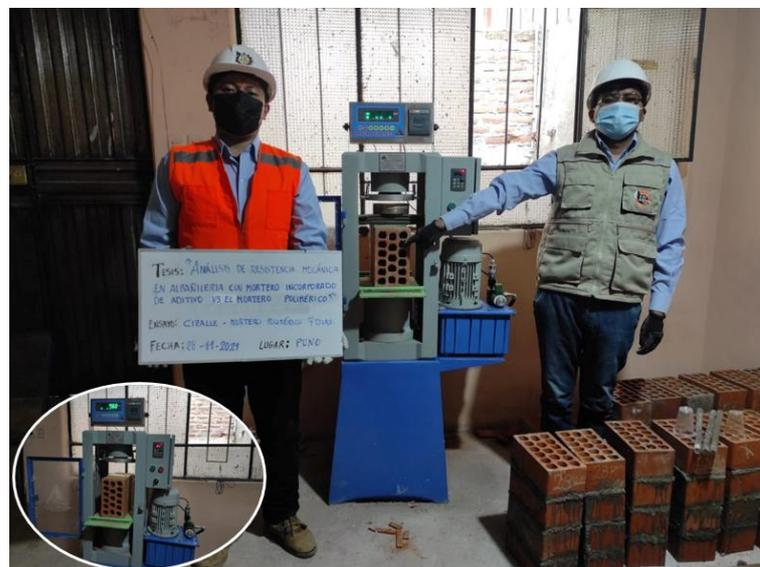
*Nota.* Ensayo de adherencia por cizalle elaborados con 03 unidades de ladrillo y con mortero polimérico Massa DunDun. Fuente: Elaborado por el equipo de trabajo.
