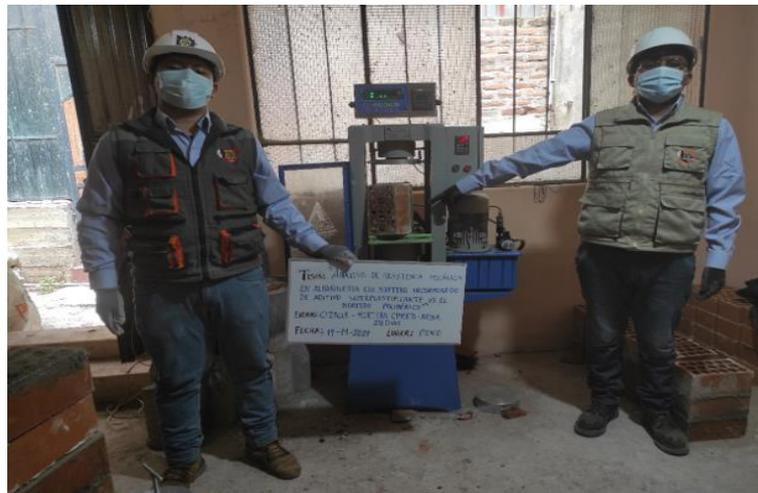
*Nota.* Ensayo de adherencia por cizalle elaborados con 03 unidades de ladrillo con mortero convencional (cemento – arena). Fuente: Elaborado por el equipo de trabajo.
