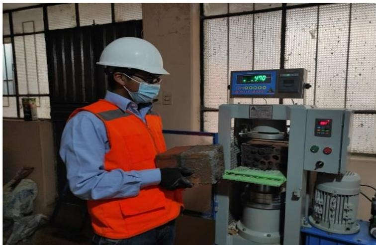
*Nota.* Retiro de la maquina la muestra después del ensayo a la flexión elaborados con 04 unidades de ladrillo y con mortero incorporado con aditivo SikaLatex®. Fuente: Elaborado por el equipo de trabajo.
