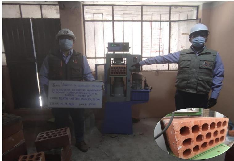
*Nota.* Ensayo a la flexión en pilas de ladrillos de cuatro unidades, elaborados con mortero polimérico Massa DunDun. Fuente: Elaborado por el equipo de trabajo.
