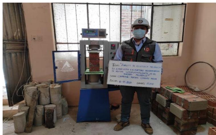
*Nota.* Ensayo a compresión en pilas de ladrillos de tres unidades, elaborados con mortero convencional (cemento – arena). Fuente: Elaborado por el equipo de trabajo.
