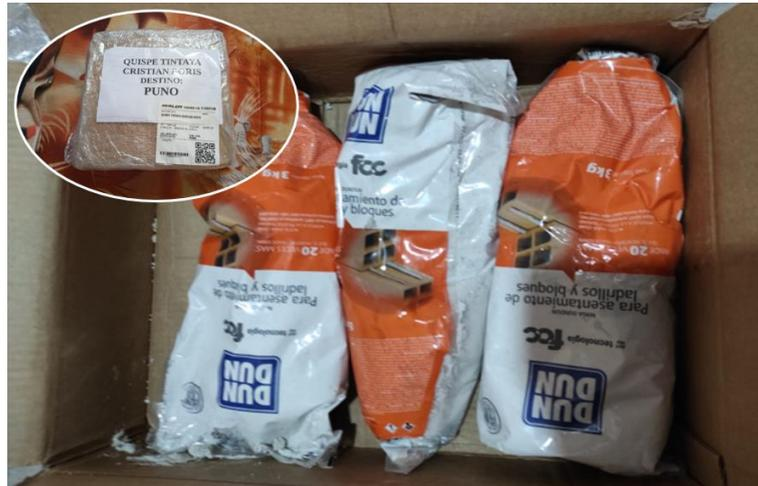
*Nota.* Massa DunDun es un mortero polimérico diseñada para el asentamiento de muros de mampostería en obra. Fuente: Elaborado por el equipo de trabajo.
