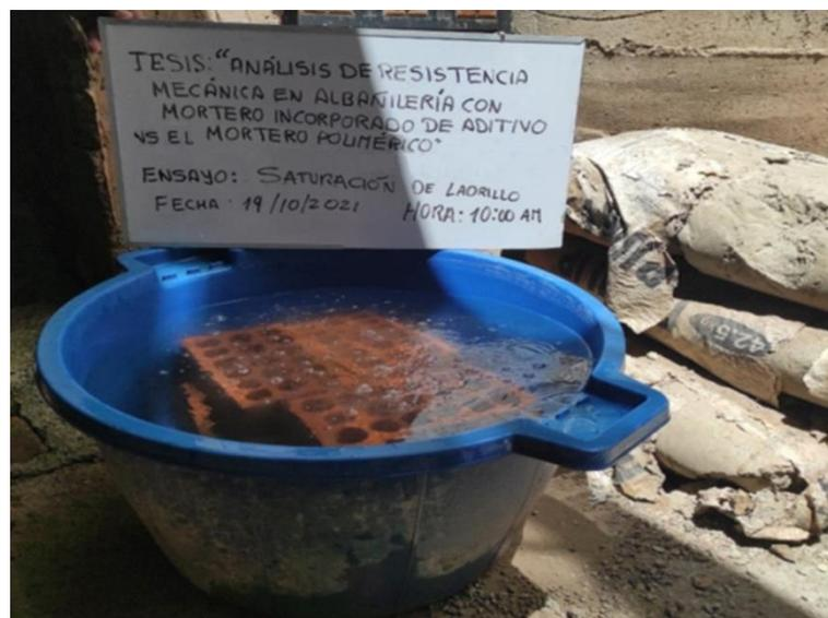
*Nota.* Saturación de cada unidad de ladrillo para posteriormente elaborar las pilas. Fuente:
