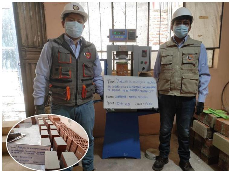
*Nota.* Ensayo a compresión en pilas de ladrillos de tres unidades, elaborados con mortero polimérico. Fuente: Elaborado por el equipo de trabajo.
