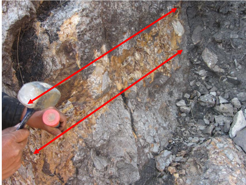
Figura 14. Muestreo en Canal de estructuras mineralizadas tipo brecha. (Fuente BD PPX Mining)
