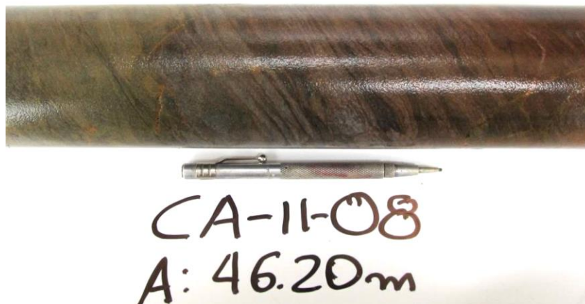
Figura 23. Muestra de perforación de diamantina A 46.20 m. arenisca masiva sin alteración (Fuente BD PPX Mining)
