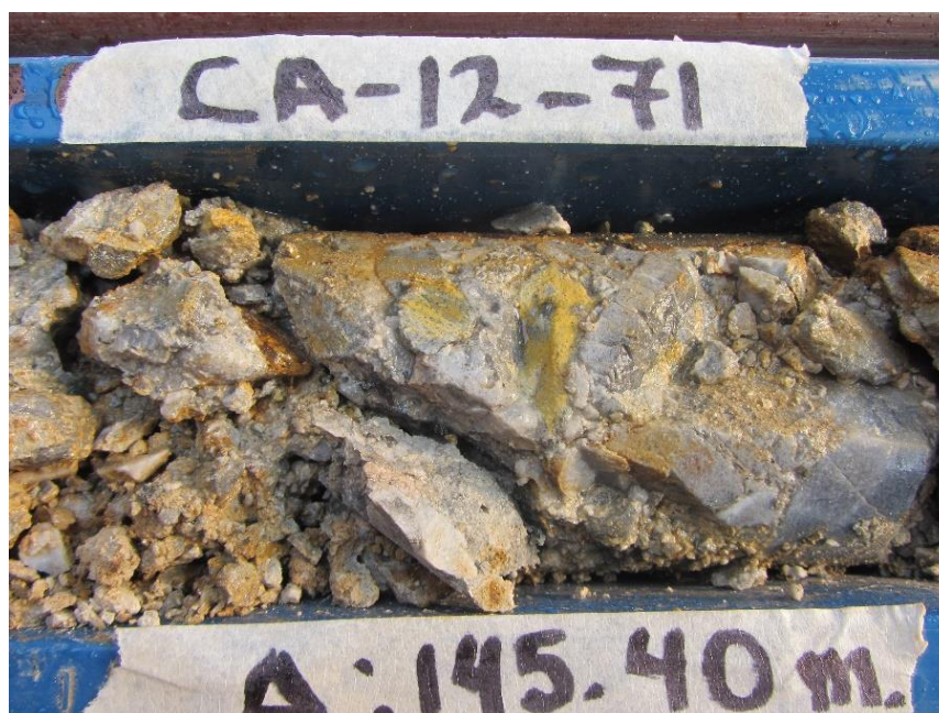
Figura 30. Muestra de perforación diamantina A 145.40 m, Brecha tectónica con matriz polvo de roca con clastos cuarciarenita, (Fuente PPX Mining).
