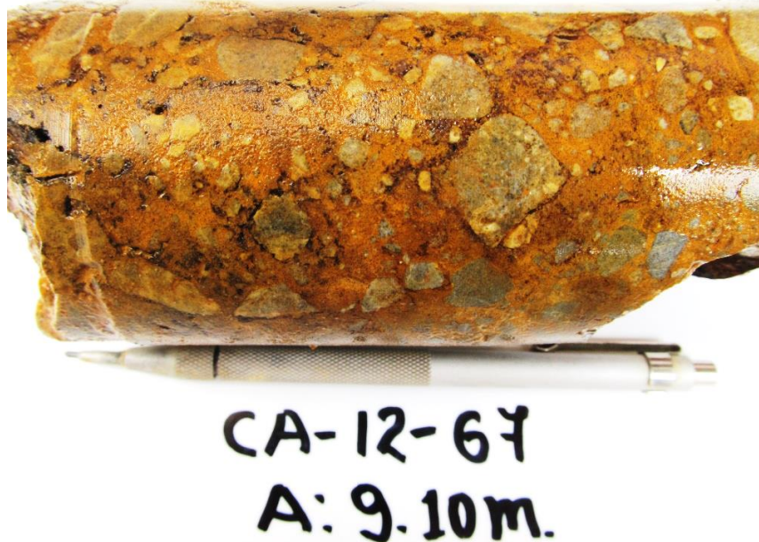
Figura 54. Muestra de perforación de diamantina A 9.10 m, del sondaje CA-12-67. Brecha hidrotermal con matriz de óxidos de hierro con fragmentos angulosos a sub redondeados de cuarciarenitas, limonitas, areniscas. (Fuente BD PPX Mining)
