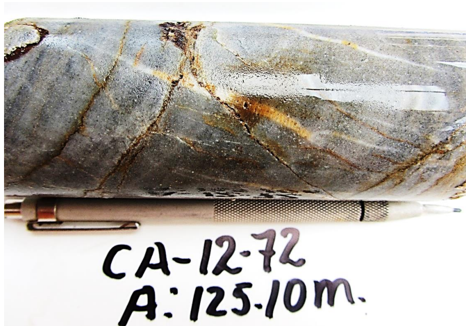
Figura 22. Muestra de perforación de diamantina A 125.10 m. Cuarciarenita con óxidos en fracturas y pirita fina diseminada. (Fuente BD PPX Mining)
