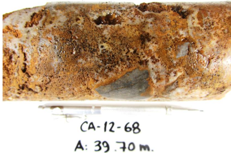
Figura 29. Muestras de perforación diamantina A 39.70 m, Veta de reemplazamiento de sílice blanca y gris oqueroso, (Fuente PPX Mining).
