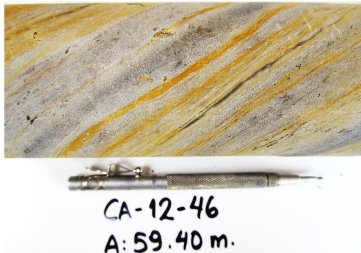
Figura 25. Muestra de perforación de diamantina A 59.40 m, Limolita arcillosa con escasos niveles de arenisca. (Fuente BD PPX Mining)
