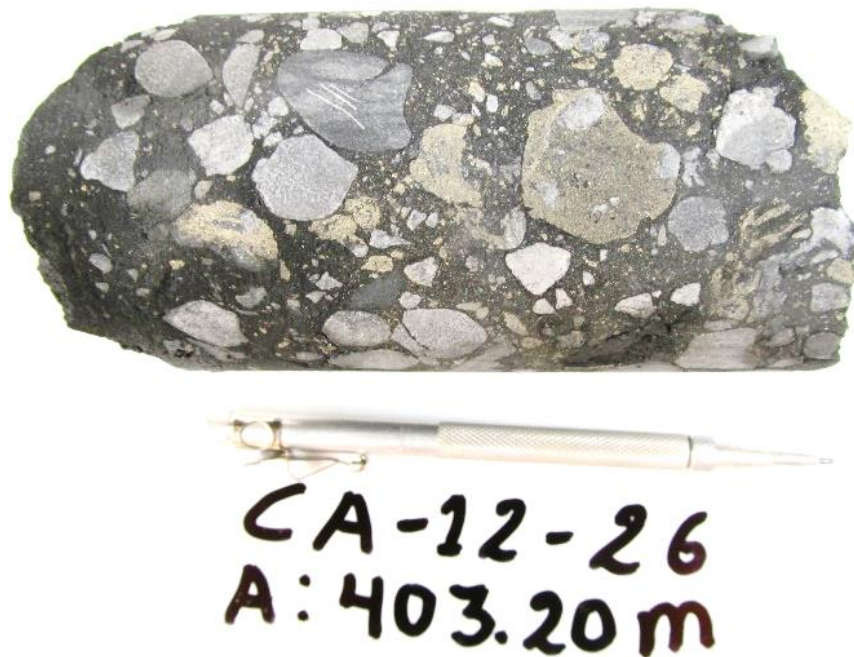
Figura 55. Foto de Pebble Dyke tomada del sondaje CA-12-26 a una profundidad de 403.20 m. fábrica mosaico a rubble, clastos de cuarziarenita, arenisca y limolita. (Fuente BD PPX Mining)
