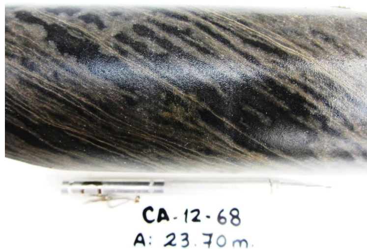
Figura 24. Muestra de perforación de diamantina A 23.70 m, Limolita arcillosa laminar con material carbonoso (Fuente BD PPX Mining)
