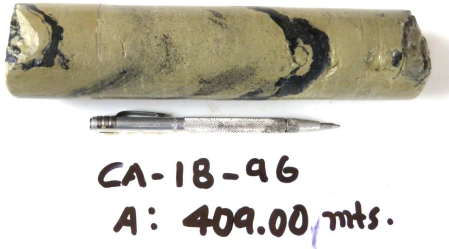
Figura 26. Volcanosedimentario con pseudo estratificación y pequeños niveles de SILC. (Fuente BD PPX Mining Corp).
