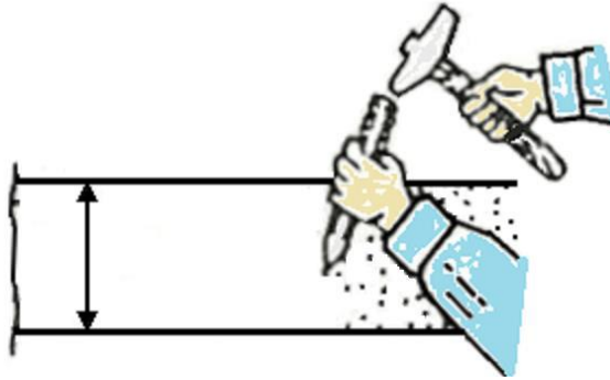
Figura 4. Canal punteado, recolección de incrementos dentro del canal (Modificado de Paredes)
