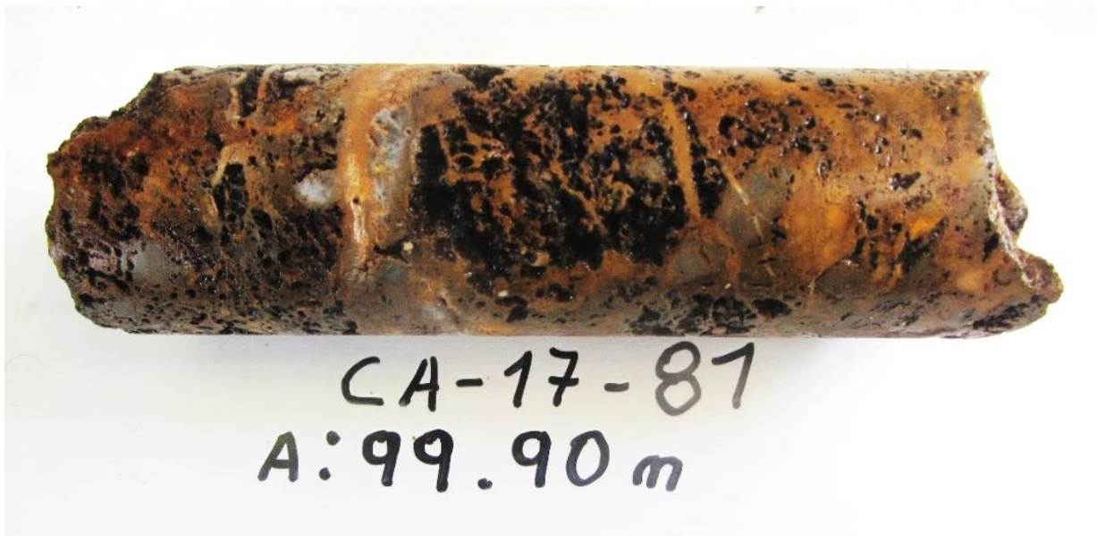
Figura 28. Muestra de perforación diamantina A: 99.90m. Veta remplazamiento de OxFe con HYBX matriz soportada de Goetita, Limonita en oquedades, (Fuente PPX Mining).
