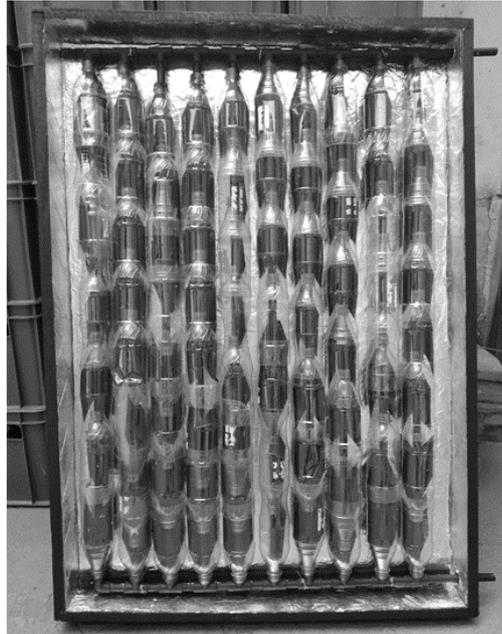
**Figura 32.** Colocación de la parrilla formada con las botellas.
