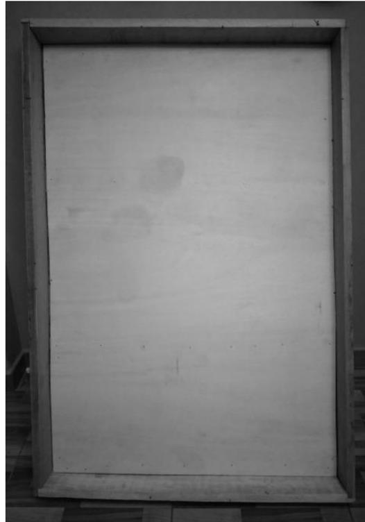
**Figura 31.** Construcción de la caja del colector.
