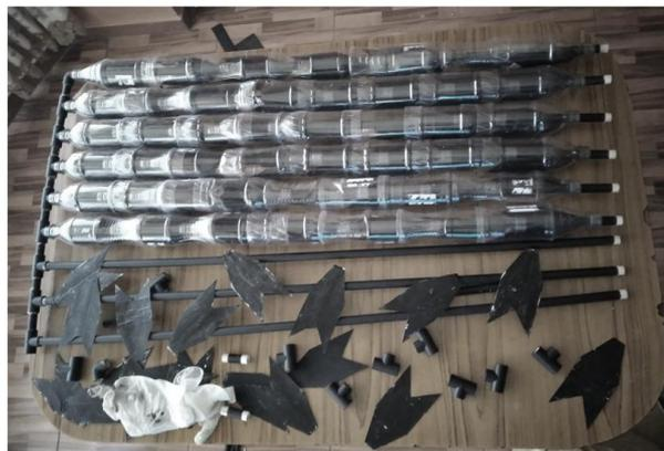
**Figura 30.** Pegado y ensamble del colector solar.
