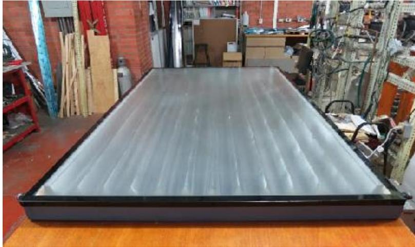
**Figura 15.** Colector concentradores parabólicos compuestos estacionarios.
