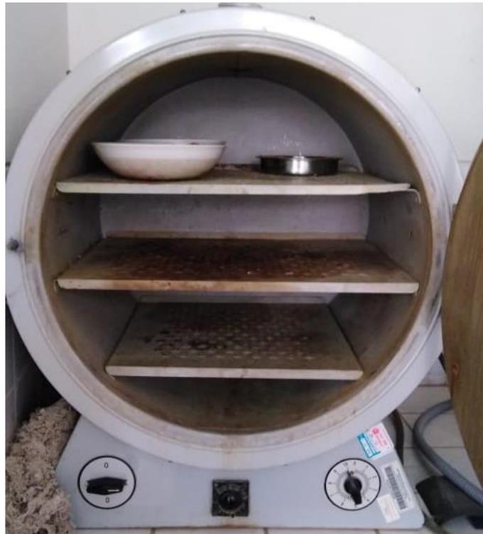
**Figura A.3.** Secado de la muestra de las semillas del aguaymanto (*physalis peruviana L.*) en la estufa
