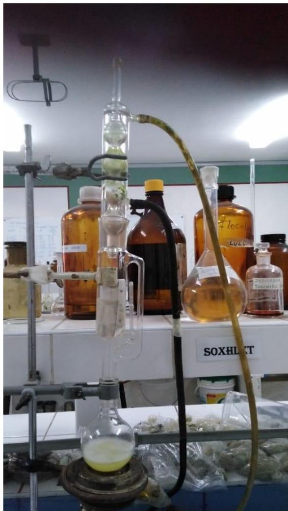
**Figura A.8.** Extracción del aceite de las semillas de Aguaymanto en el equipo Soxhlet
