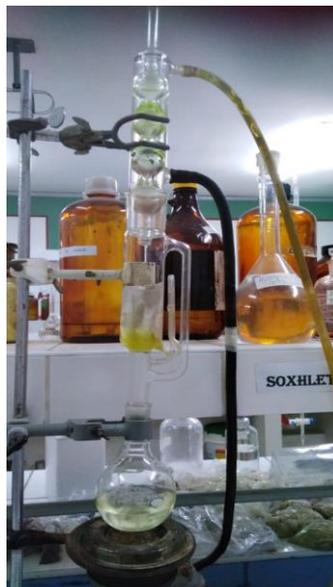
**Figura 14.** Extracción del aceite de las semillas de (*Physalis peruviana* L.)
