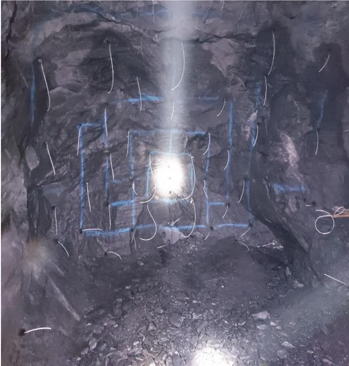
Figura 22. Carguío de la malla de corte en "V".
