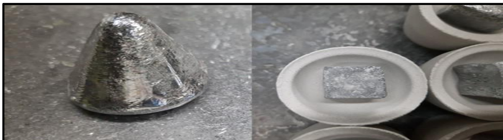
Figura 16. Régulos para darles forma de cubos
