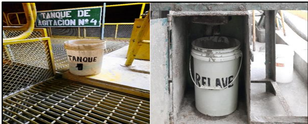
Figura 4. Muestreo de cabeza de cianuración tanque No 1 y relave final
