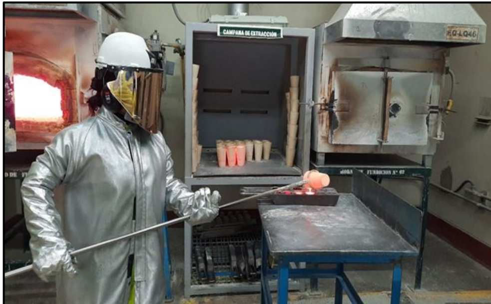
Figura 15. Colada del contenido del crisol en el centro de las cavidades de las lingoteras
