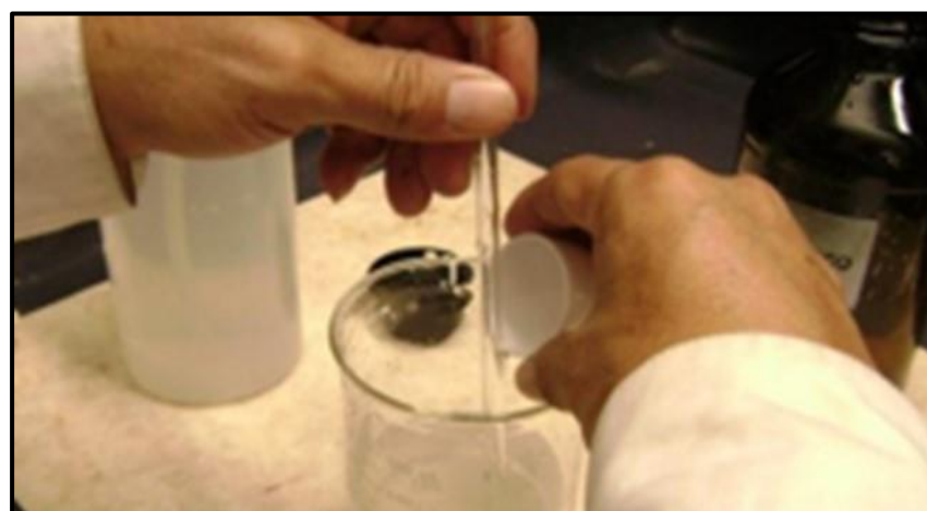
Figura 21. Lavado para obtener oro libre
