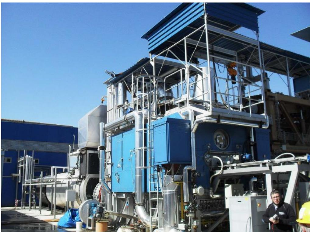
*Figura 33.* Planta de gasificación VERONA
