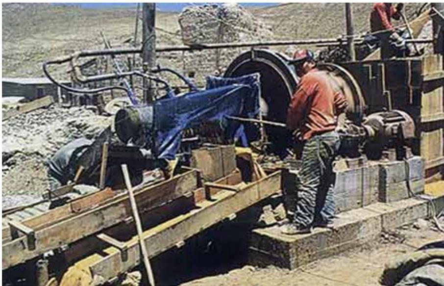
*Figura N° 10: Canaletas con diferentes pisos (alfombras, metal expandido) para diferentes tamaños de carga clasificados por un trómel en la salida de un molino a bolas.*
