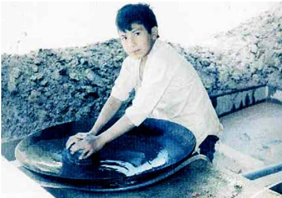
*Figura N° 4: Amalgamación manual dentro de una batea metálica grande.*
