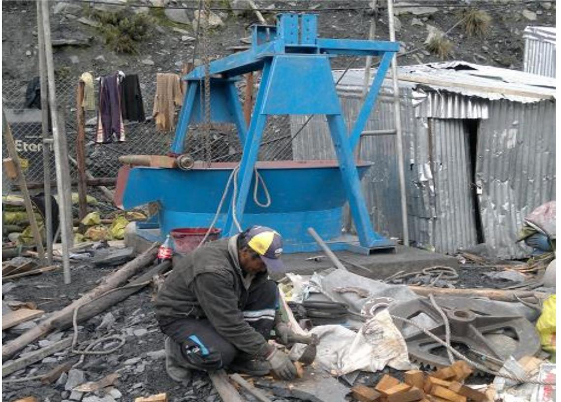
*Figura N° 18: Armado de Estructura del Trapiche*
