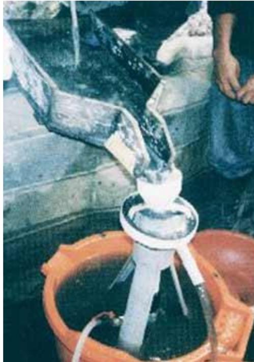
*Figura N° 15: Separador hidráulico*
