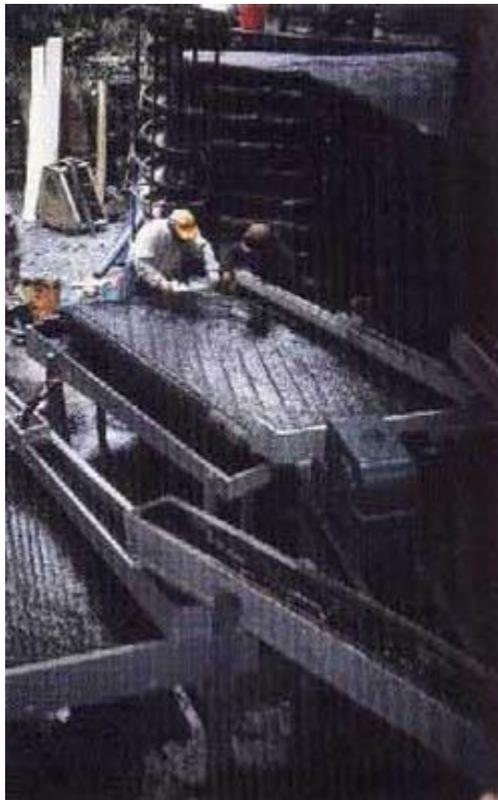
*Figura N° 12: Mesa concentración gravimétrica.*
