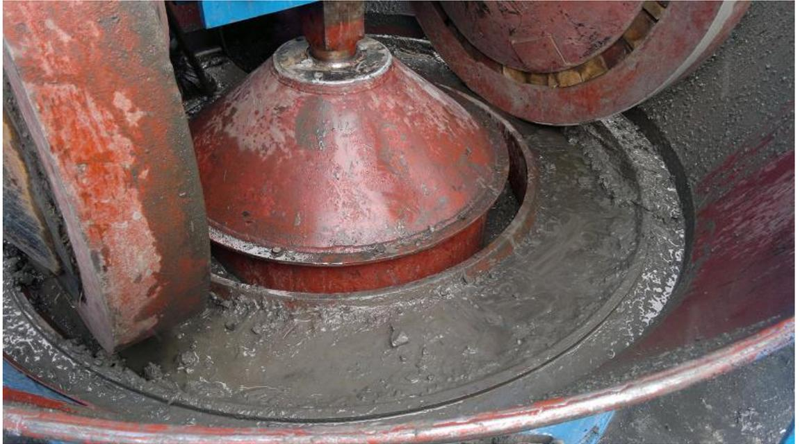
*Figura N° 20: Ruedas Trituradoras, Tina de Concentración*
