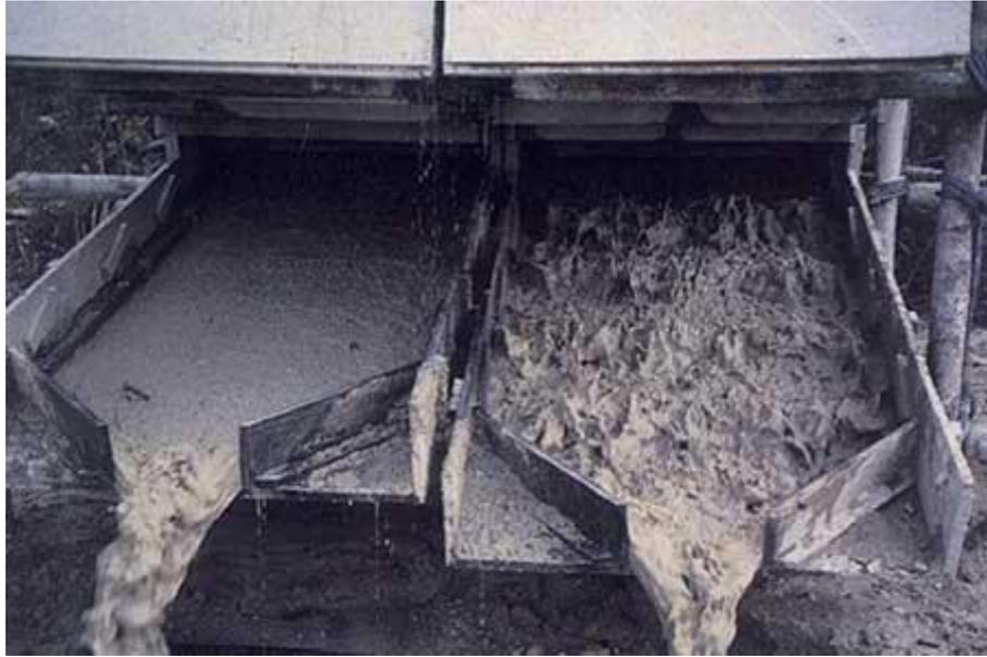
*Figura N° 9: (Canaleta) experimental; alta turbulencia: tradicional, baja turbulencia: modificada.*
