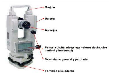
Figura 7. Operación del teodolito
