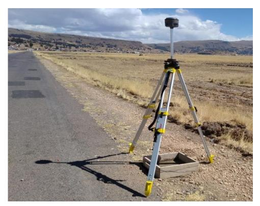
*Figura 29.* Obtención de coordenadas de los puntos de control con el GPS Fuente: Elaborado por el equipo de trabajo
