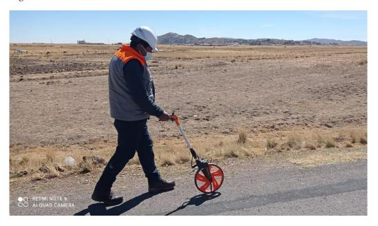
Figura 37. Medición de distancia con Odómetro digital
