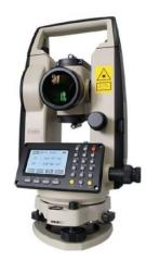
*Figura 2*. Teodolito electrónico Fuente: Delgadillo, 2013
