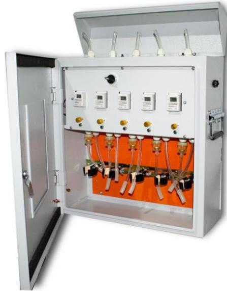
**Figura 10.** Tren de muestreo para 5 gases
