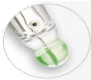
Figura N° 32: Bulbo de un pH-metro de vidrio
