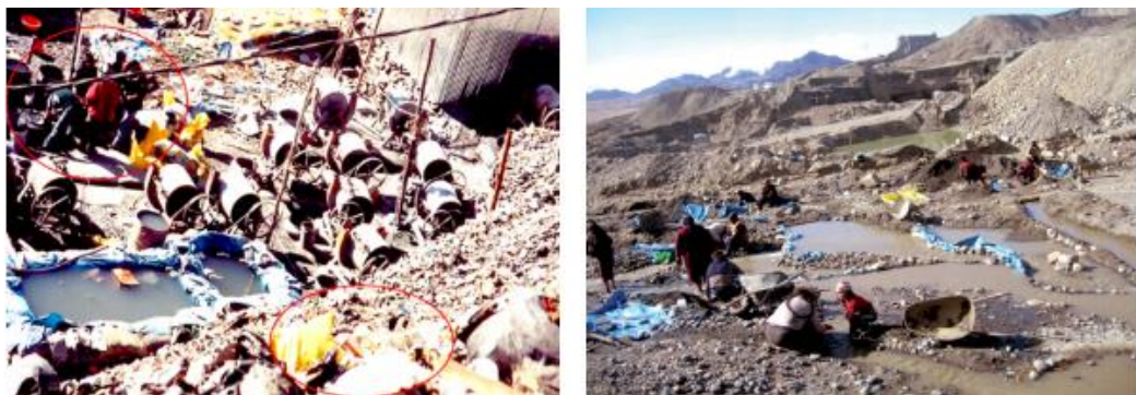
Figura 14. Tecnificación artesanal, uso de molinetes eléctricos, mayor contaminación (izquierda), uso de cianuro en minería informal, sin control (derecha)
