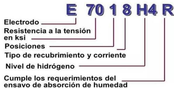
**Figura 7.** Clasificación AWS - A.5.1 para electrodos
