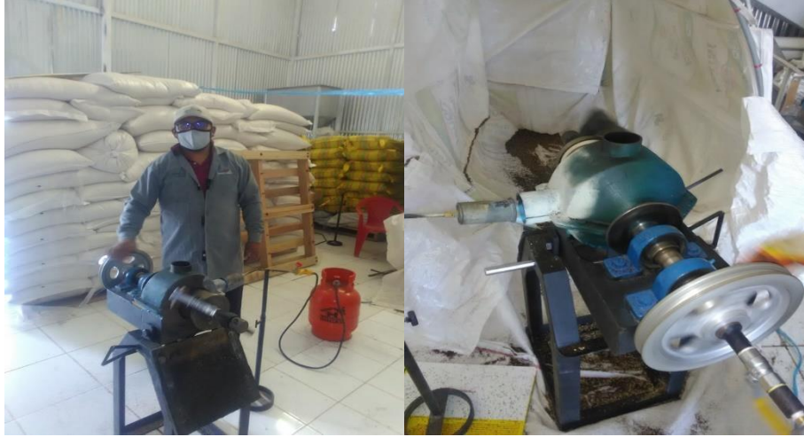
Figura 13. Cañón expansor de un solo disparo modelo Boliviano.
