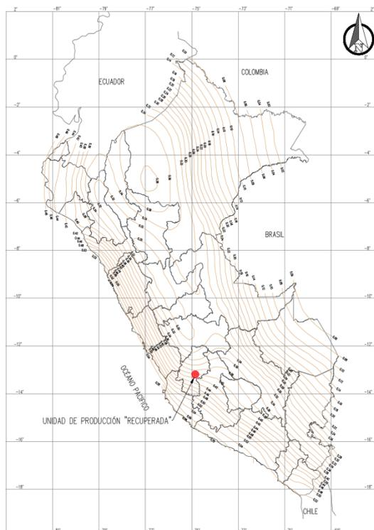
De la figura se relaciona la aceleración y su probabilidad anual de excedencia y considerando un coeficiente lateral sísmico entre 1/2 a 2/3 del valor de la aceleración horizontal máxima considerada. Considerando un periodo de retorno de 100 años y un 50% de la aceleración máxima el coeficiente sísmico (aceleración de diseño) es 0.20g.
