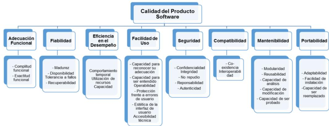
Figura 6. Modelo para calidad interna y externa del producto software
