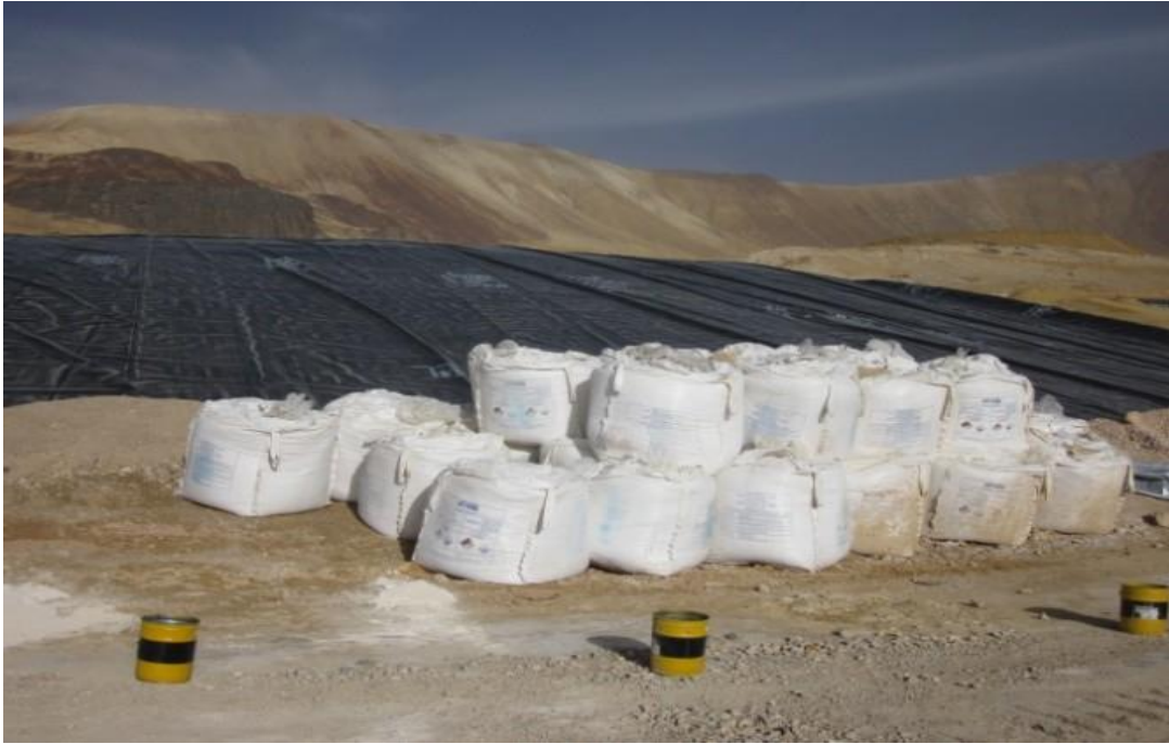
Figura 14. Almacenamiento de cal en la zona de descarga del Pad de Lixiviación.
