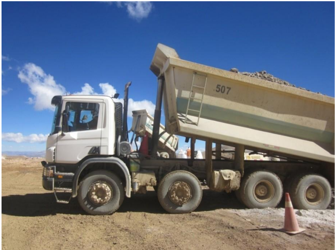
Figura 12. Recepción del Mineral, zona de descarga Lift 10 celda N° 38.
