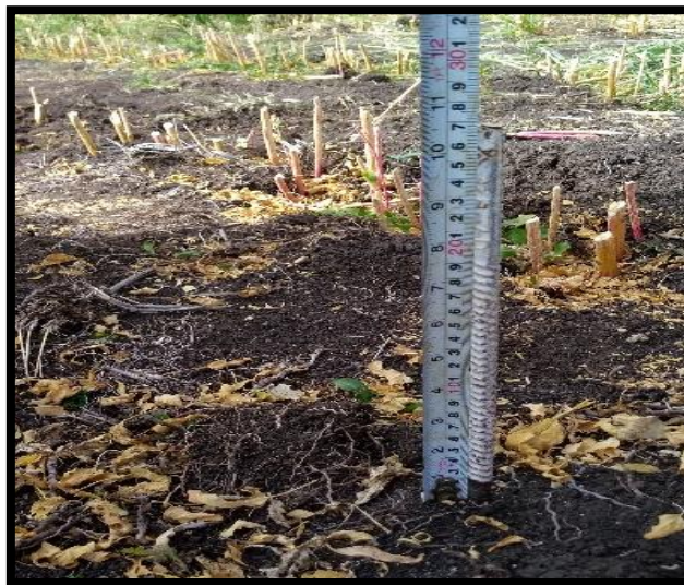
Figura 38. Medición de la erosión del suelo con wincha métrica
