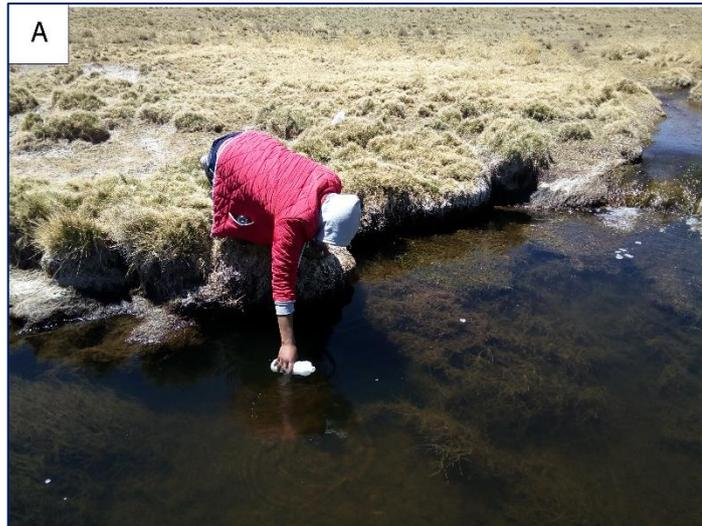
**Figura 107.** Se muestra la forma en cómo se obtuvo la muestra, exactamente se observa cómo se realizó el enjuagado de las botellas de polietileno (3 veces).
