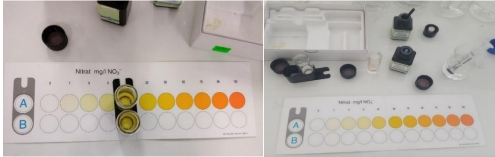
Figura 31. Determinación de nitratos en muestras de las aguas del río Cañipía, Laboratorio de Botánica y Biotecnología, FCCBB – UNA Puno, setiembre – noviembre 2019.
