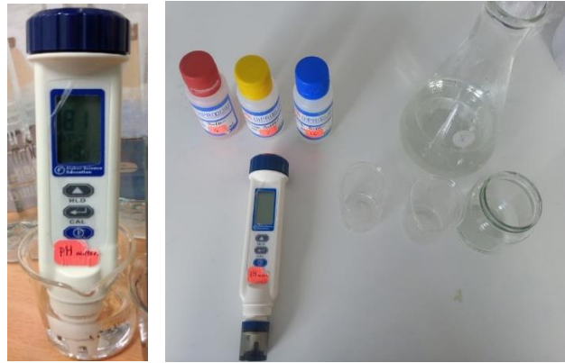
Figura 34. Determinación del pH en muestras de las aguas del río Cañipía, Laboratorio de Botánica y Biotecnología, FCCBB – UNA Puno, setiembre – noviembre 2019.
