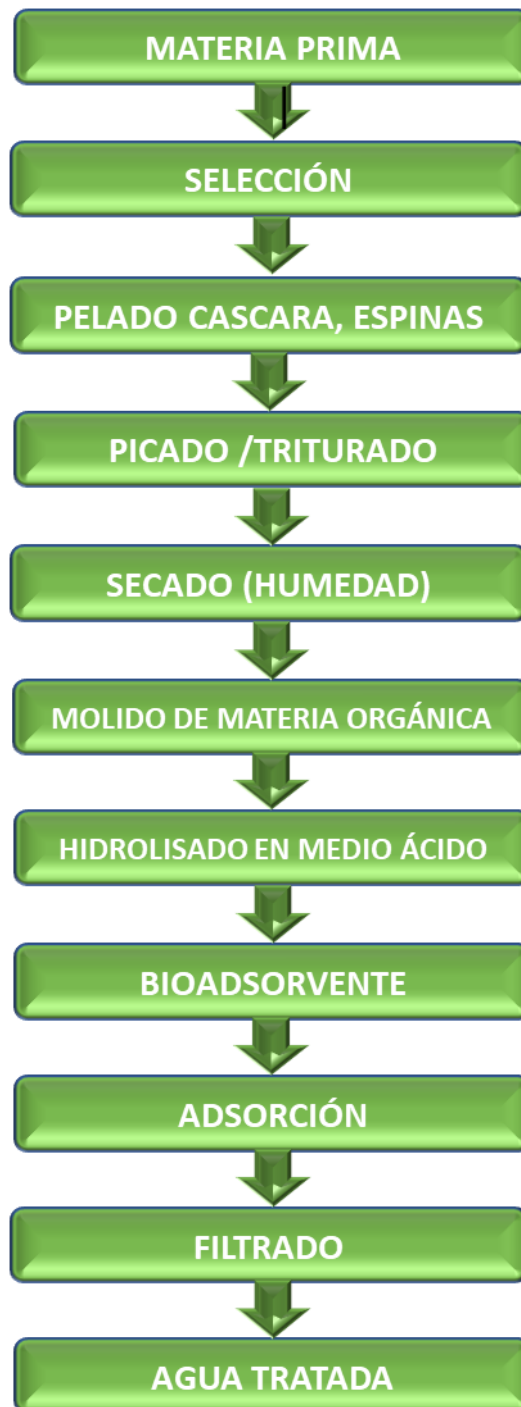
Figura 6. Digrama de flujo de obtención de bioadsorbente del Arsénico (As)
