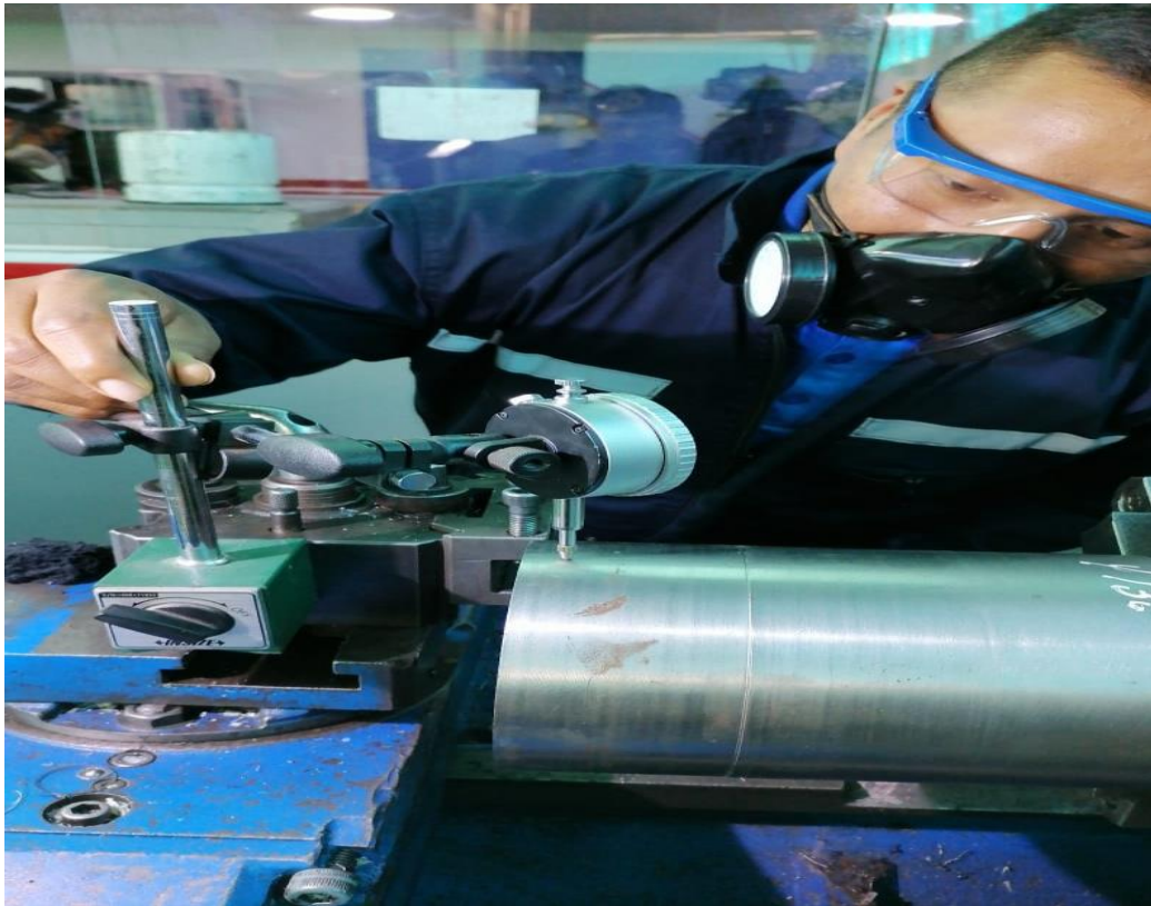
Figura 31. Verificación de medidas finales
