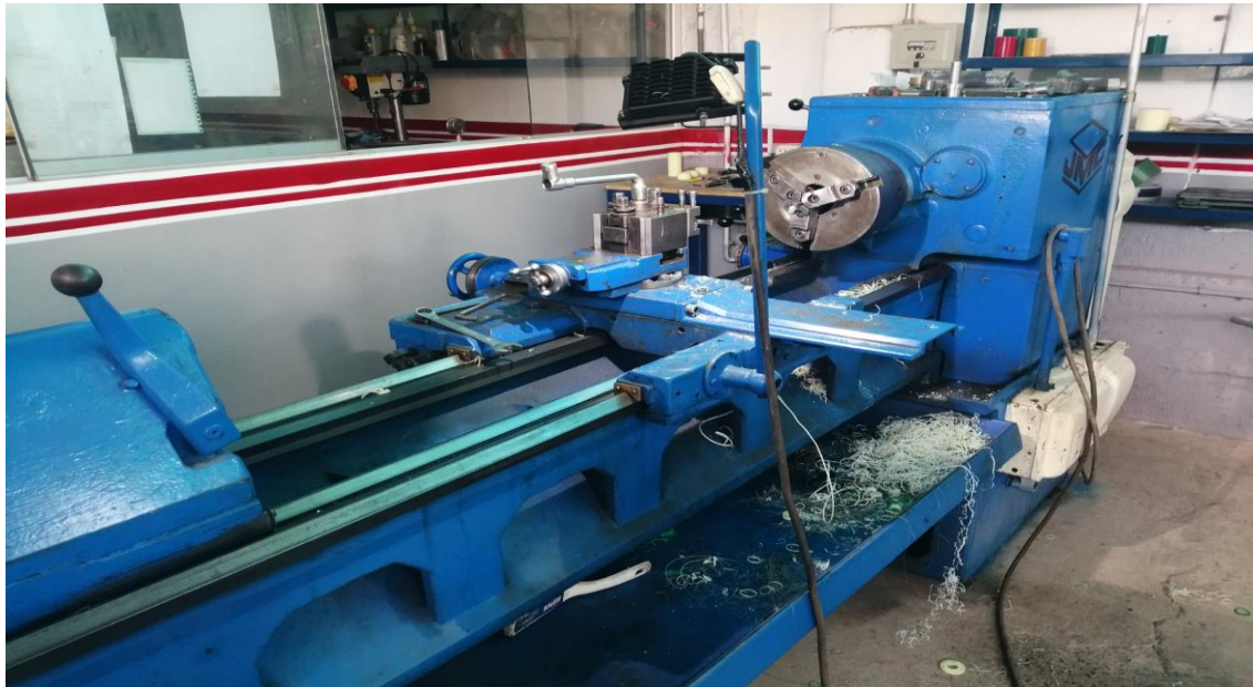
Figura 29. Torno de marca Turn-nado utilizado para preparar las probetas
