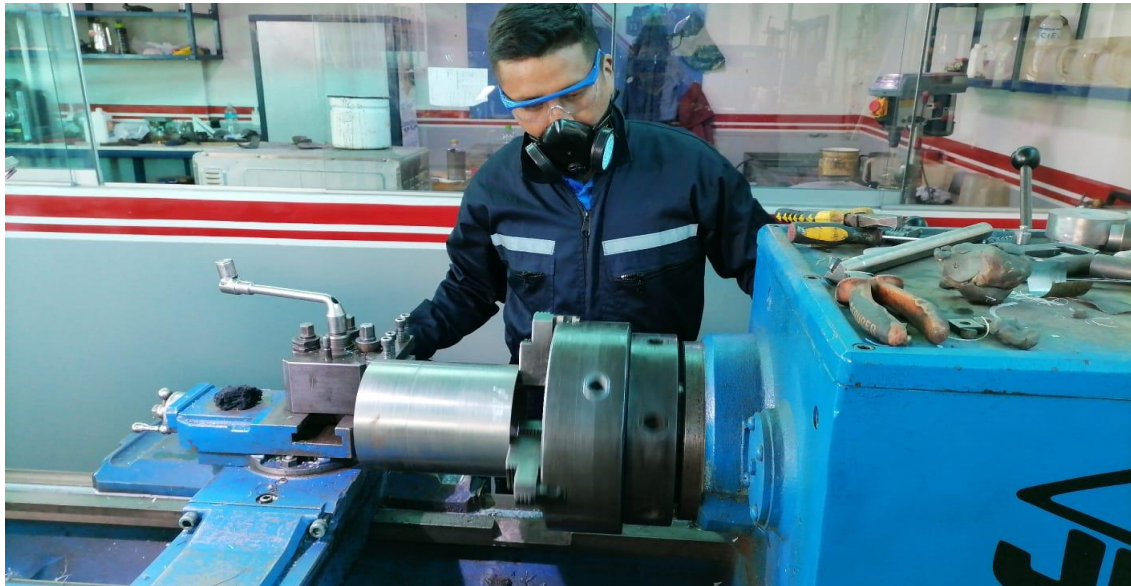
Figura 25. Preparación de probetas en JMC Soluciones
