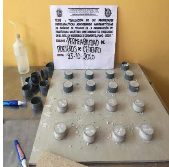
Figura 207: Desmoldado de muestras para ensayo de permeabilidad.
