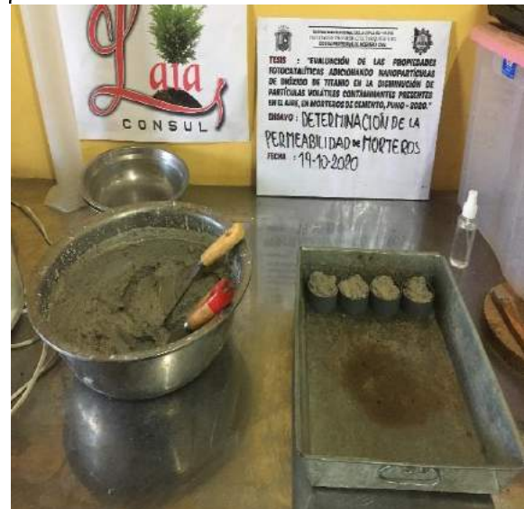
Figura 205: Llenado de probetas para ensayo de permeabilidad.
