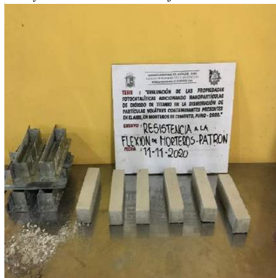
Figura 184: Desmoldado de probetas de mortero para ensayo de resistencia a la flexión.
