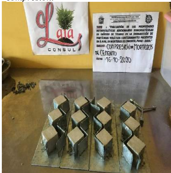
Figura 172: Desmoldado de probetas para ensayo de compresión.
