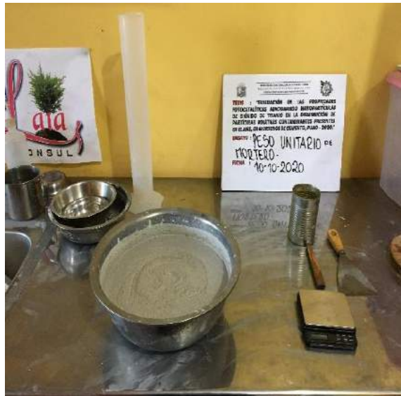
Figura 131: Reposo de mezcla para elaboración de morteros.
