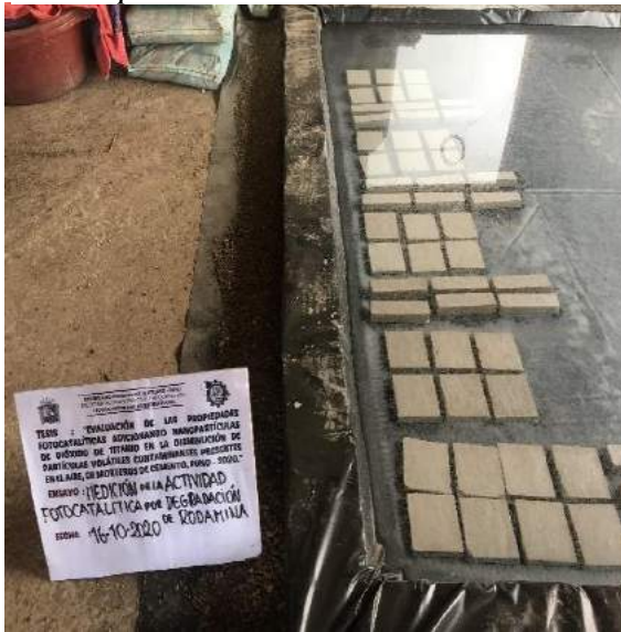
Figura 159: Curado en poza de curado para ensayo de autolimpieza.
