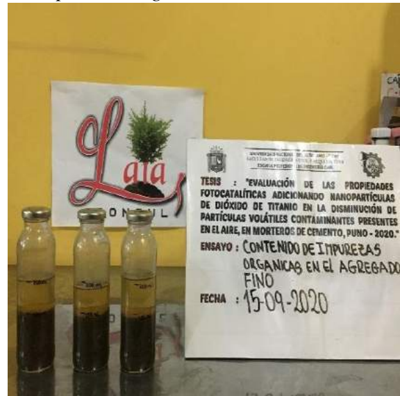
Figura 125: Contraste del color del liquido para ensayo de impurezas organicas.
