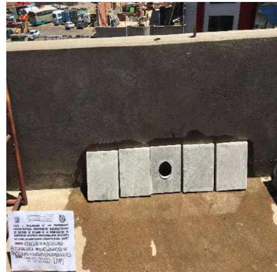
Figura 154: Lavado de probetas para ensayo de descontaminación.
