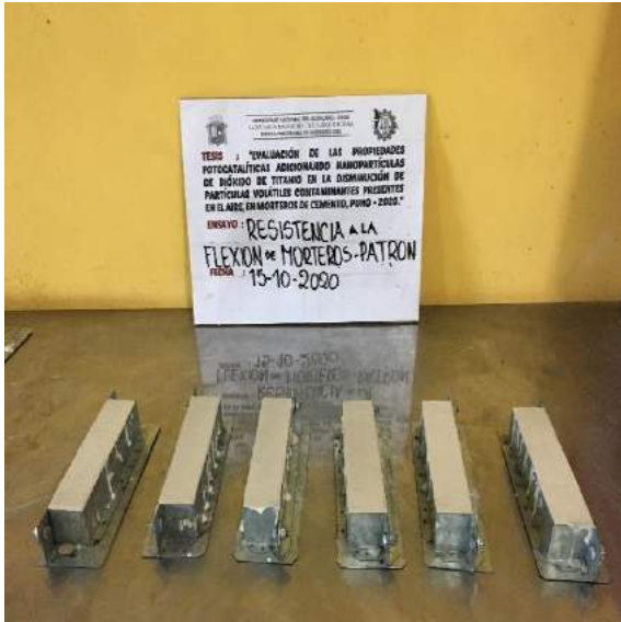
Figura 182: Enrasado de probetas para ensayo de resistencia a la flexión.
