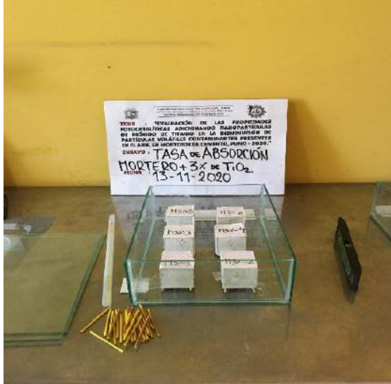
Figura 202: Colocado de muestras en el recipiente para ensayo de absorción.
