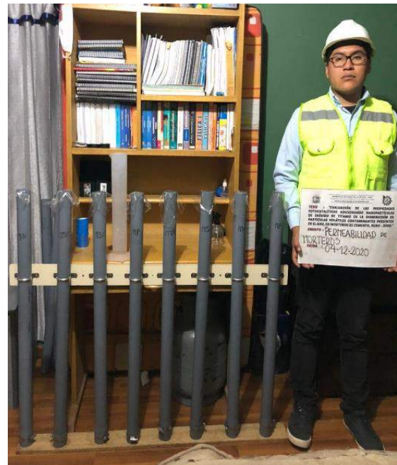
Figura 212: Ensayo de permeabilidad.
