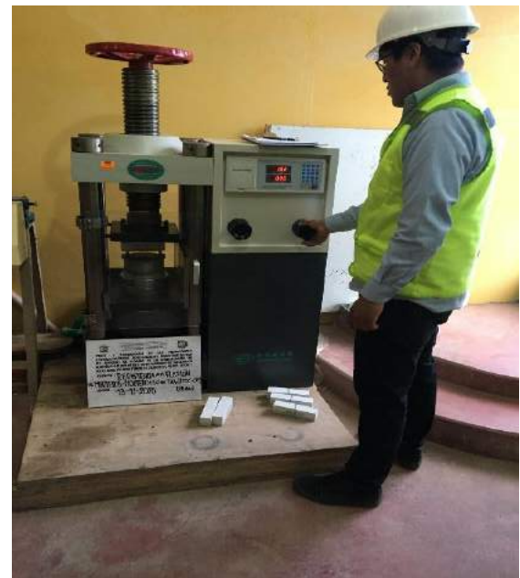
Figura 193: Ensayo de resistencia a la flexión de morteros.
