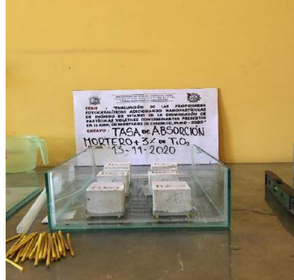
Figura 203: Llenado de recipiente con agua para ensayo de absorción.
