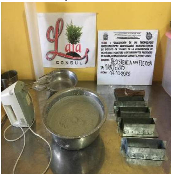
Figura 180: Elaboración de mortero para ensayo de resistencia a la flexión.
