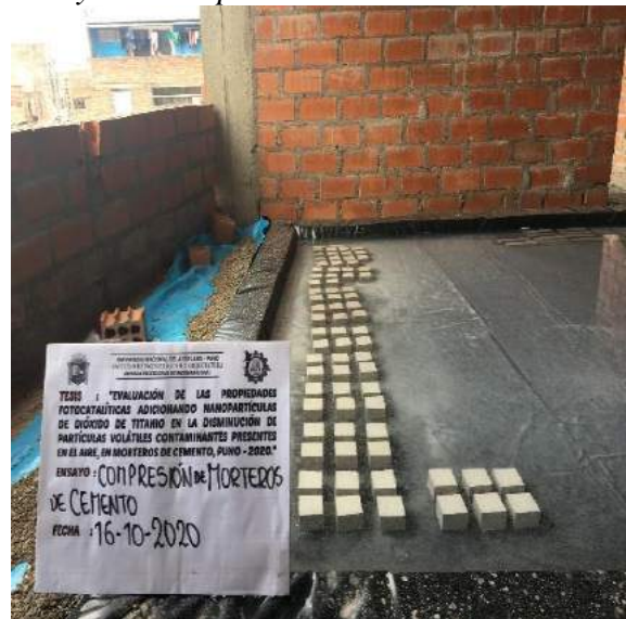
Figura 173: Curado de probetas en poza de curado para ensayo de compresión.
