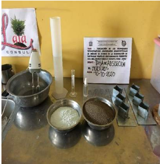
Figura 195: Elaboración de mortero para ensayo de absorción.
