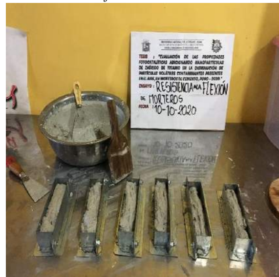
Figura 181: Llenado de moldes para ensayo de resistencia a la flexión.
