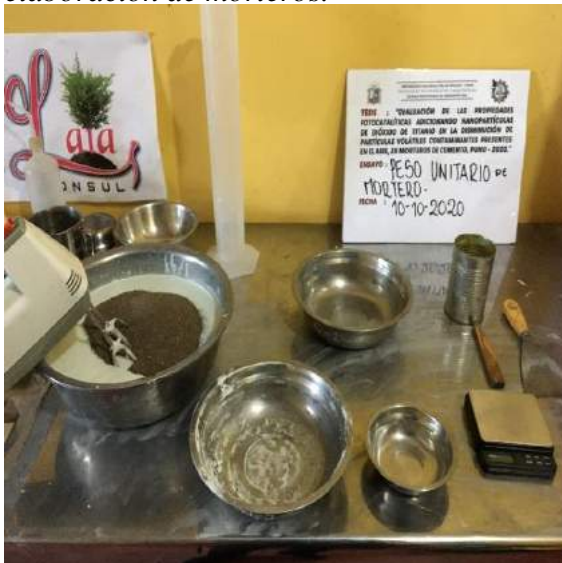
Figura 130: Adición de agregado fino para elaboración de morteros.
