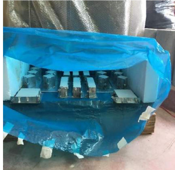
Figura 171: Curado de probetas en cámara húmeda para ensayo de compresión.
