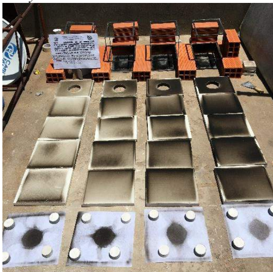
Figura 153: Exposición de probetas a los rayos UV para ensayo de descontaminación.
