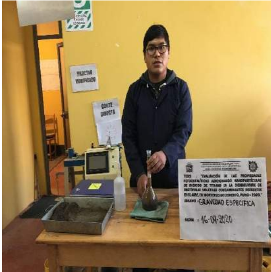
Figura 116: Eliminación de aire para ensayo de gravedad específica.
