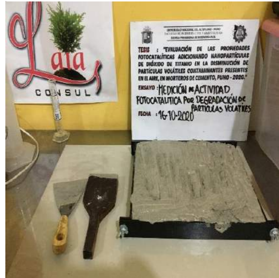
Figura 144: Llenado de moldes para ensayo de descontaminación.
