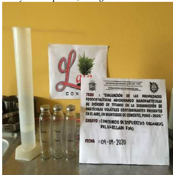
Figura 123: Preparado de insumos y materiales para ensayo de impurezas orgánicas.
