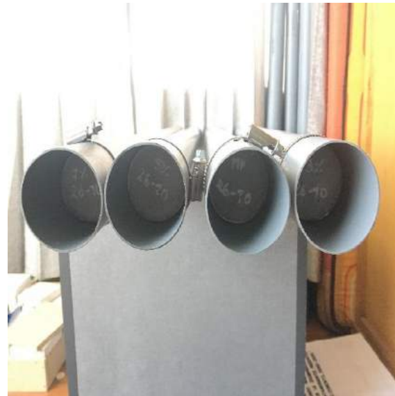
Figura 211: Montaje para ensayo de permeabilidad.
