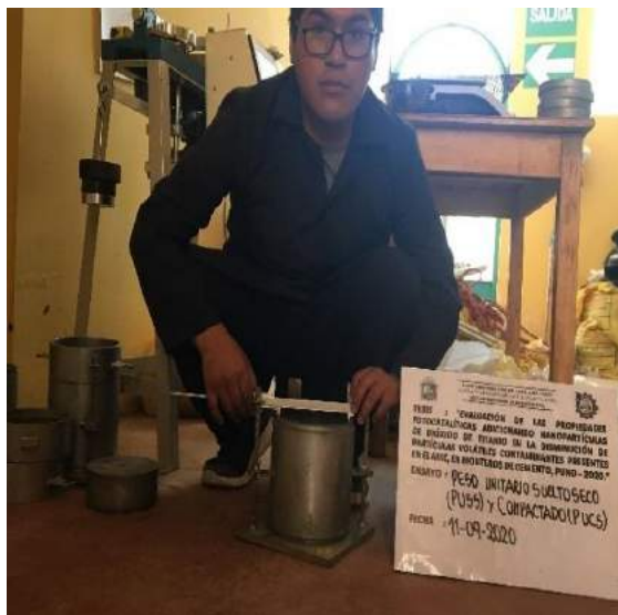
Figura 118: Calculo del volumen del molde para ensayo de peso unitario.
