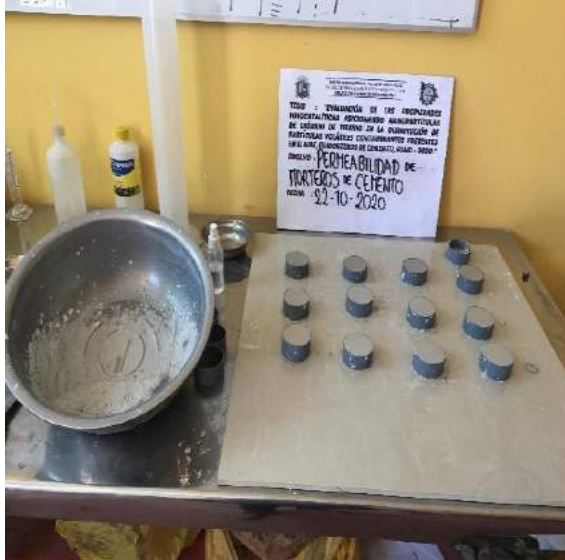
Figura 206: Enrasado de probetas para ensayo de permeabilidad.
