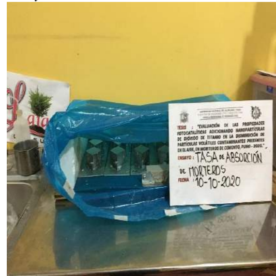
Figura 197: Curado de Probetas en cámara húmeda de ensayo de absorción.
