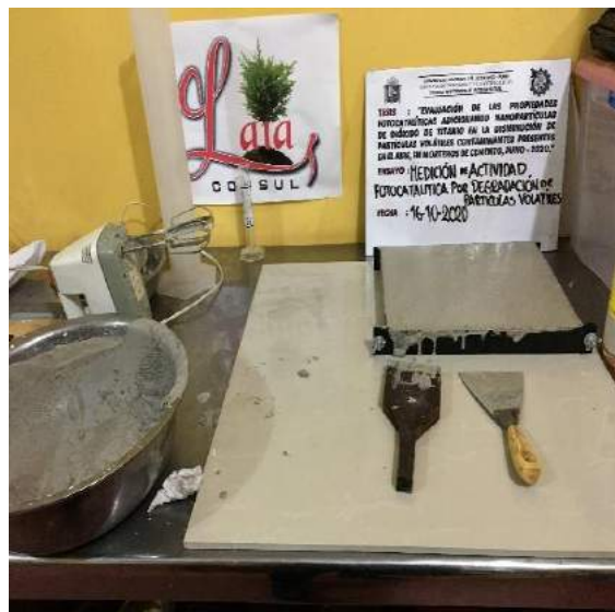
Figura 145: Enrasado de probetas para ensayo de descontaminación.
