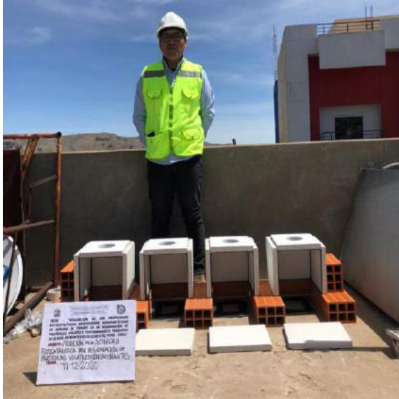
Figura 151: Colocación de probetas en fogones para ensayo de descontaminación.
