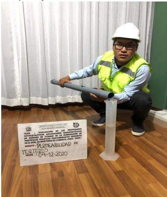
Figura 213: Medida de la cantidad de agua para ensayo de permeabilidad.
