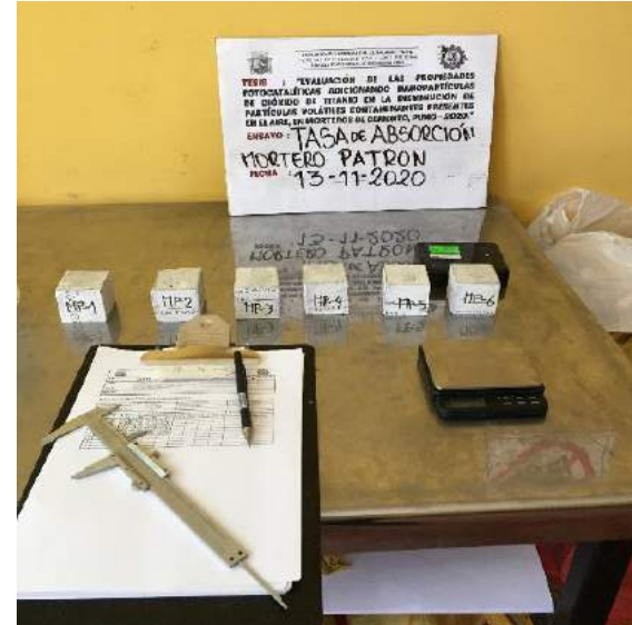
Figura 201: Medida de probetas para ensayo de absorción.
