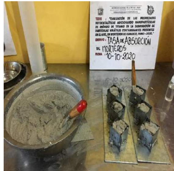
Figura 194: Llenado de probetas para ensayo de absorción.
