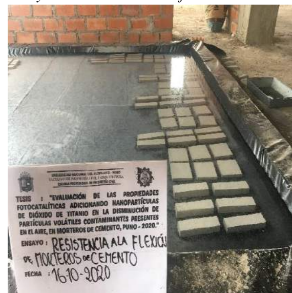
Figura 185: Curado de probetas en poza de curado para ensayo de resistencia a la flexión.
