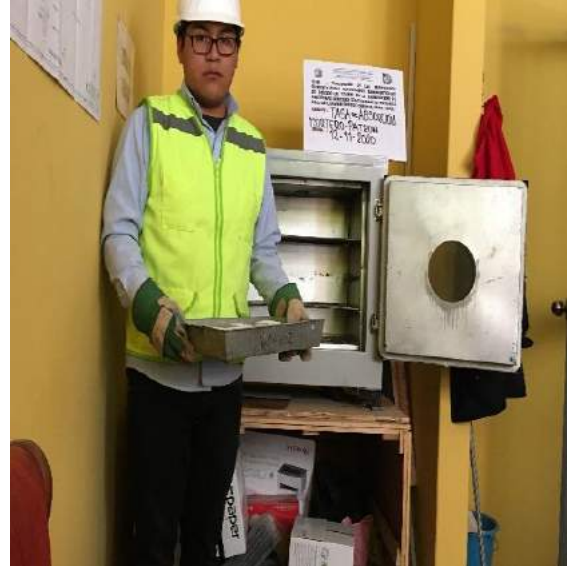
Figura 199: Secado de probetas para ensayo de absorción.
