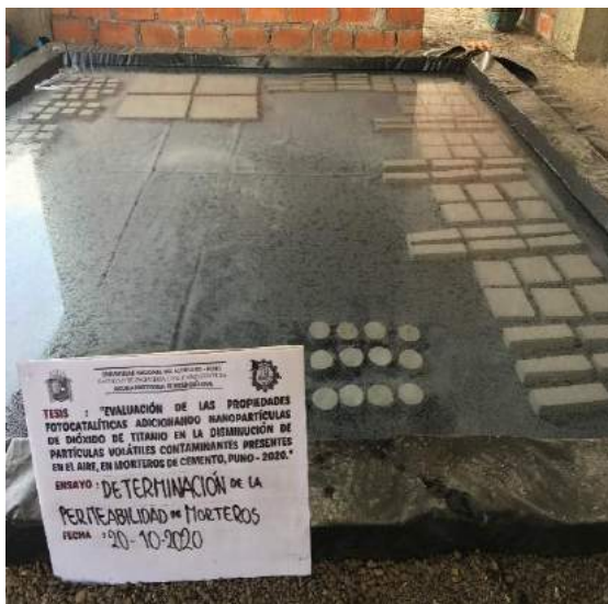
Figura 208: Curado de probetas para ensayo de permeabilidad.
