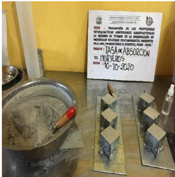
Figura 196: Enrasado de Probetas para ensayo de absorción.
