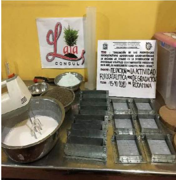
Figura 128: Adición de dióxido de titanio para elaboración de morteros.
