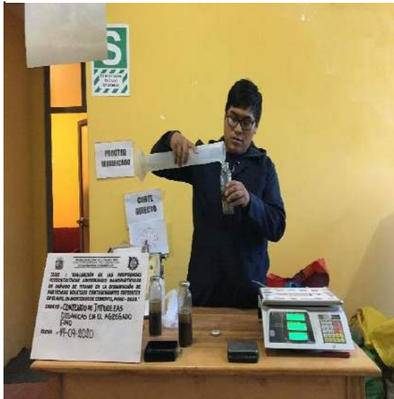
Figura 124: Mezcla de agua y la soda caustica para ensayo de impurezas organicas.
