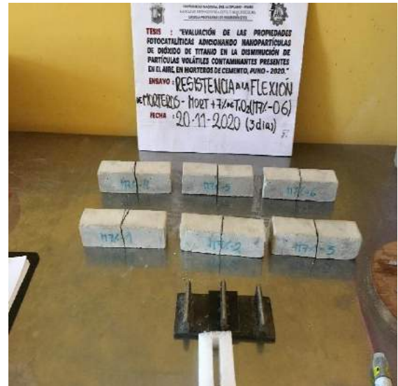
Figura 191: Falla de probetas de mortero a ensayo de flexión.
