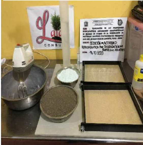
Figura 143: Elaboración de mortero para ensayo de descontaminación.
