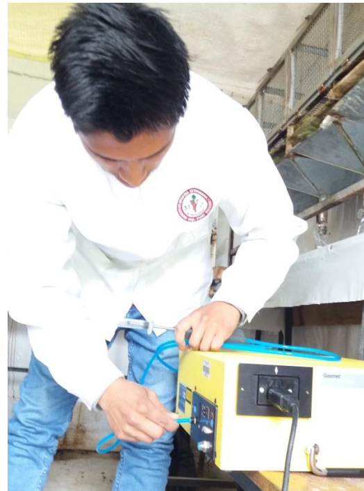
Figura 31. Visualización del equipo Gaset DX-403 y colocación de la manguera poliuretano al equipo
