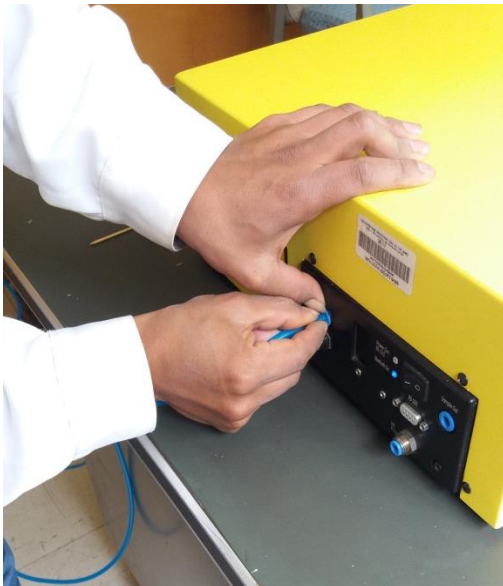
Figura 30. Colocación de la manguera poliuretano para calibrar
