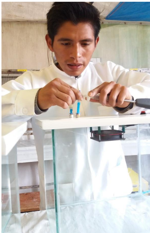
Figura 34. Colocación del colector (sensor) por donde pasa la muestra de (CH 4 )
