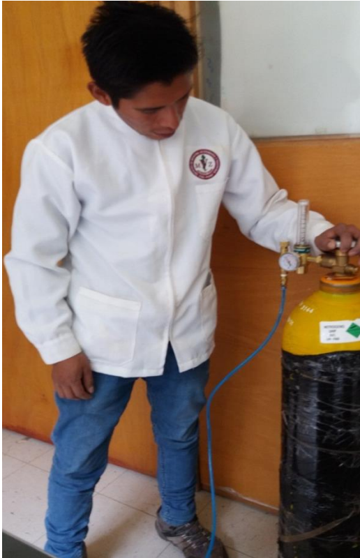
Figura 28. Apertura de la llave de la válvula del tanque de Nitrógeno UHT (99.999 N)
