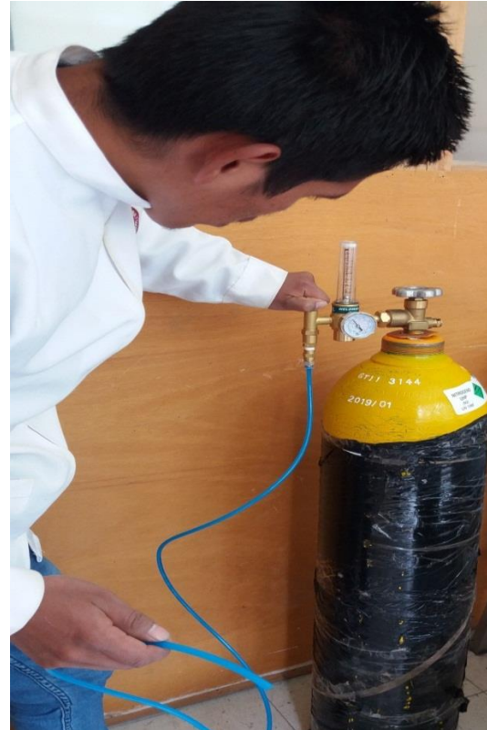
Figura 27. Abrir la perilla reguladora, fijándose que el manómetro ejerza una presión en cilindro de 5L
