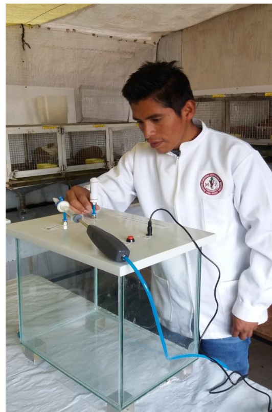
Figura 33. Colocación de la conexión del ventilador mecánico y termómetro digital en la tapa 34.
