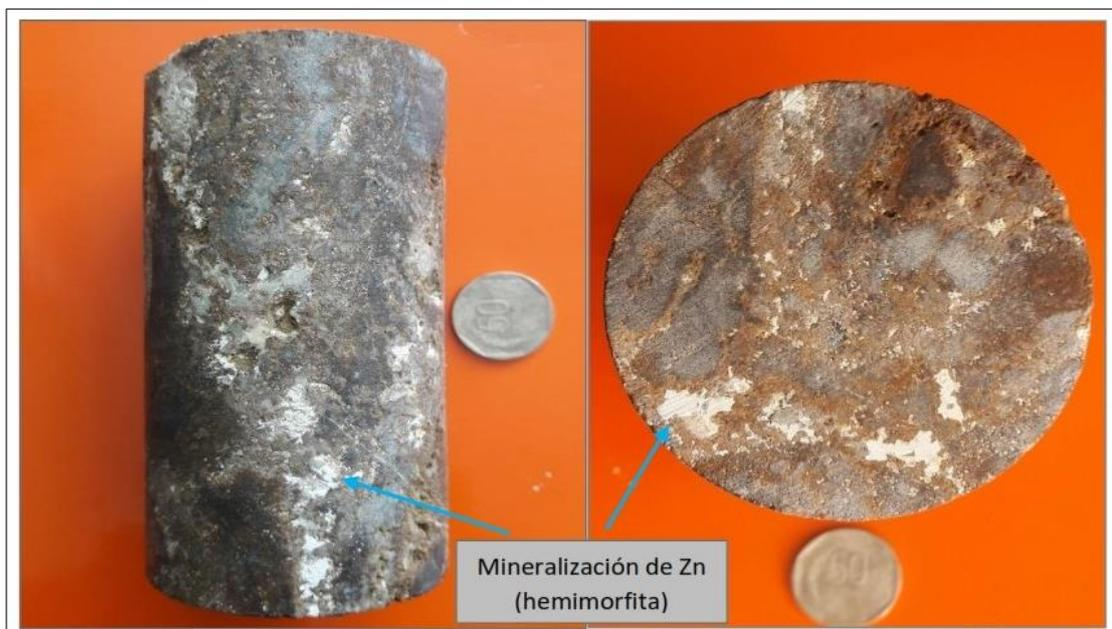
**Figura 18.** En la imagen se observa una muestra de dolomita brechada perteneciente al sondaje MCH-18-048 del sector Mina Chica, con mineralización de óxidos de Zn en las cavidades de disolución.
