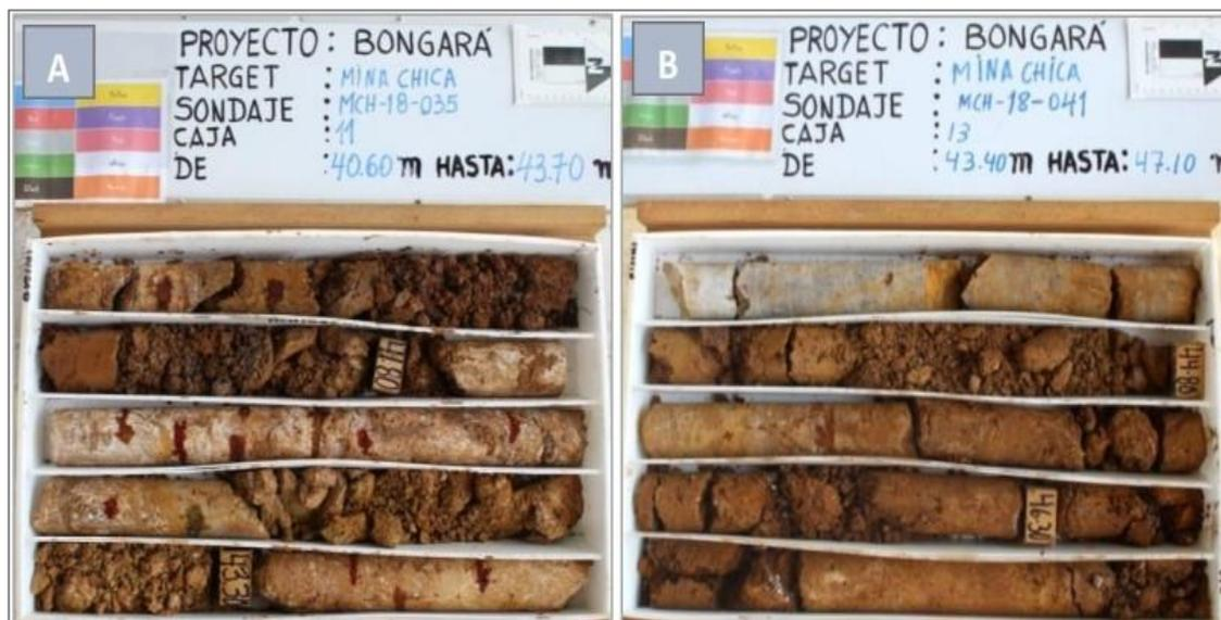
**Figura 37.** Mineralización representativa en el proyecto Bongará – Mina Chica. A) En la imagen se observa la mineralización de alta ley > 20% Zn en el sondaje MCH-18-035, B) Mineralización de Zn representativa en el sondaje MCH-18-041, la mineralización de óxidos de zinc se encuentran hospedadas en dolomitas.
