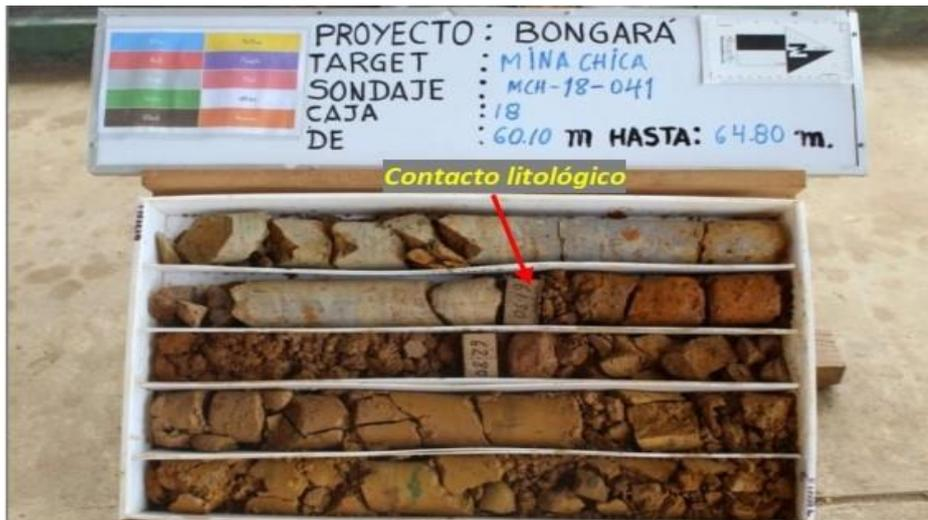
**Figura 28.** Zona de contacto entre calizas y dolomitas, en la parte superior caliza gris inalterada y parte inferior dolomita con mineralización de zinc.
