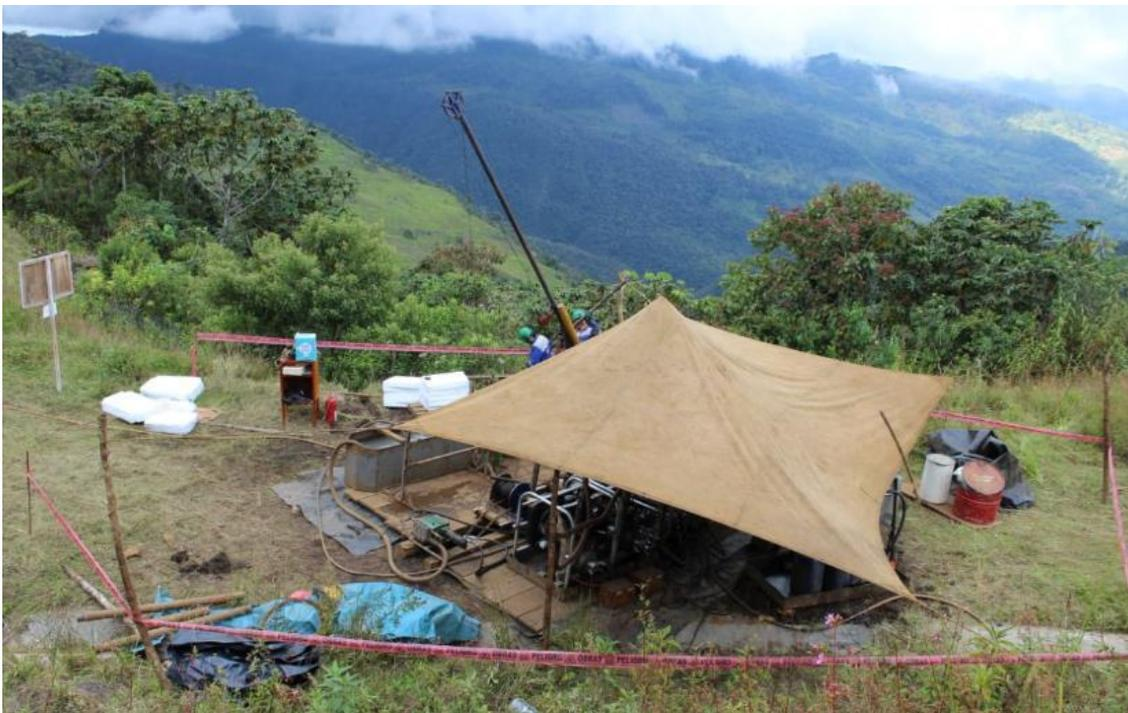
**Figura 36.** Ejecución del programa de perforación diamantina en el Proyecto Bongará, trabajo realizado por la empresa *Energold Drilling S.A.C.*
