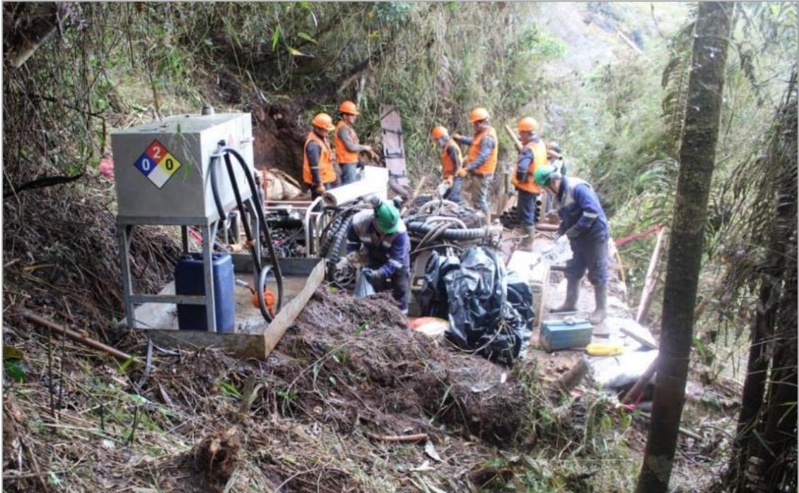
**Figura 35.** Proceso de instalación de la máquina perforadora en Mina Chica.
