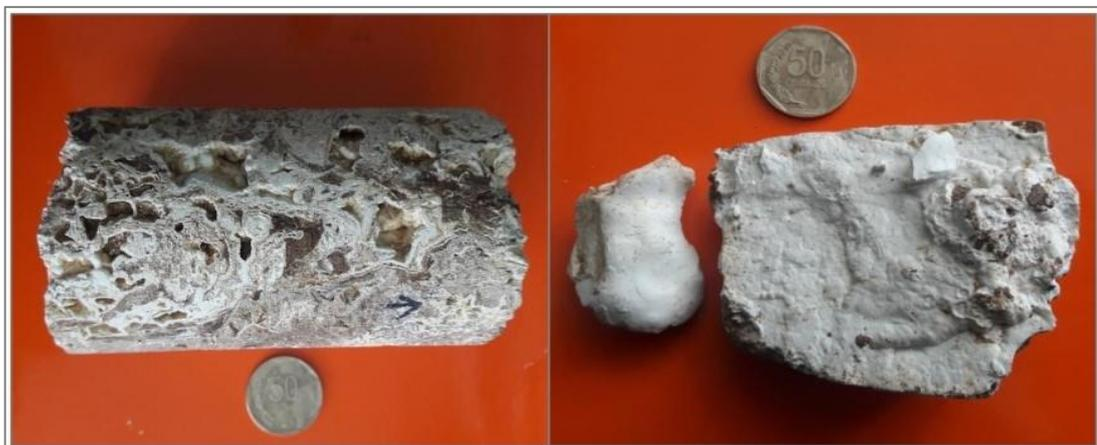
**Figura 15.** Mineralización típica de hemimorfita e hidrocincita con alta ley de zinc en Mina Chica.
