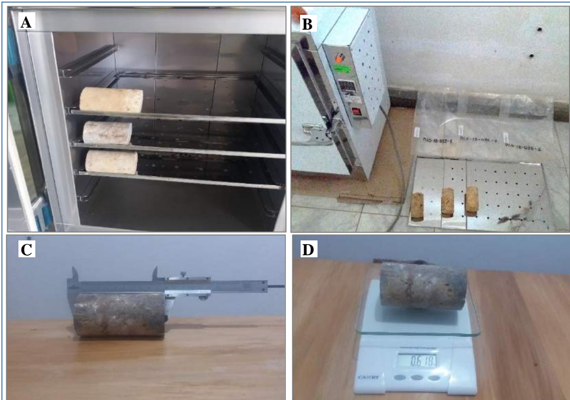
Foto 09: Procedimientos para obtención de la densidad de muestras mineralizadas. A) Secado de muestras de testigos, B) Enfriado de muestras a temperatura de ambiente, C) Medición de la longitud y diámetro de la muestra de testigo con el calibrador D) Medición del peso de la muestra con balanza digital.
