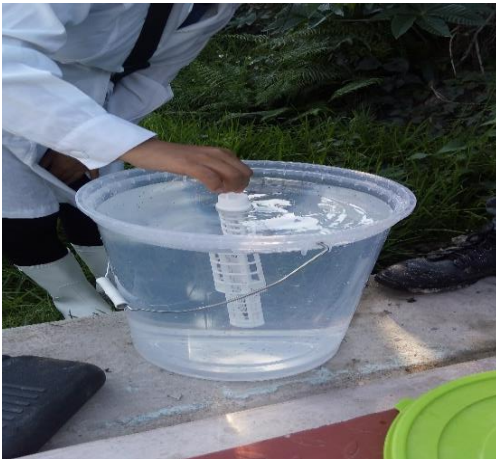
Figura 48. Toma de temperatura y pH de las muestras
