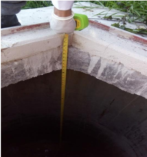
Figura 47. Toma de medida de profundidad de pozas para muestreo
