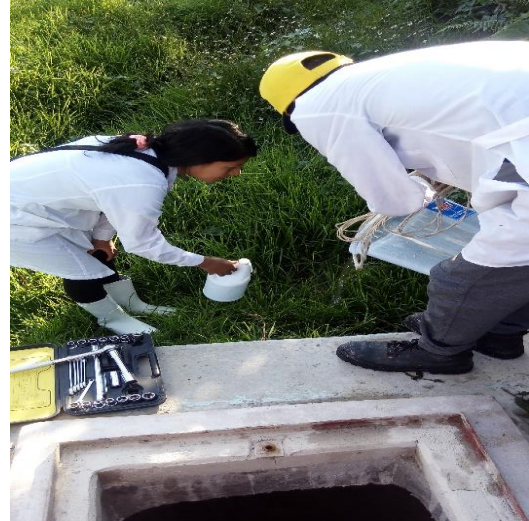
Figura 47. Toma de medida de profundidad de pozas para muestreo
