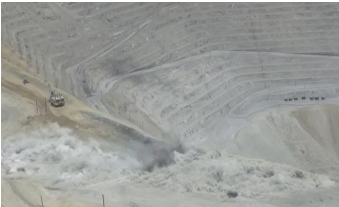
Figura 18: No genera gases nitrosos con MEQ 73
