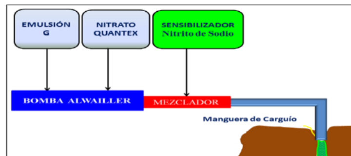
Figura 6: Flujo de nitrato de Sodio para gasificar MEQ73 según el flujo de descarga de la mezcla explosiva.
