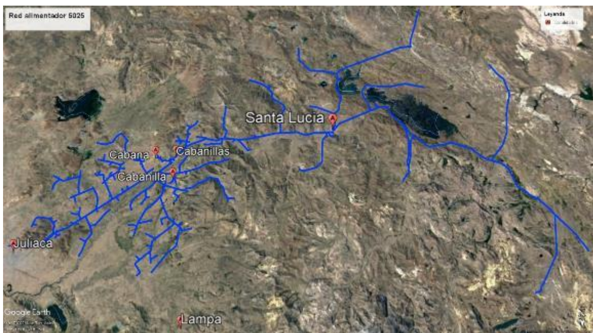
Figura N° 25: Red del Sistema Eléctrico de Distribución en 22.9kv Cabanillas - Santa Lucía ingresado en el Software Google Earth Pro Elaborado por el equipo de trabajo – Datos Electro Puno S.A.A.
