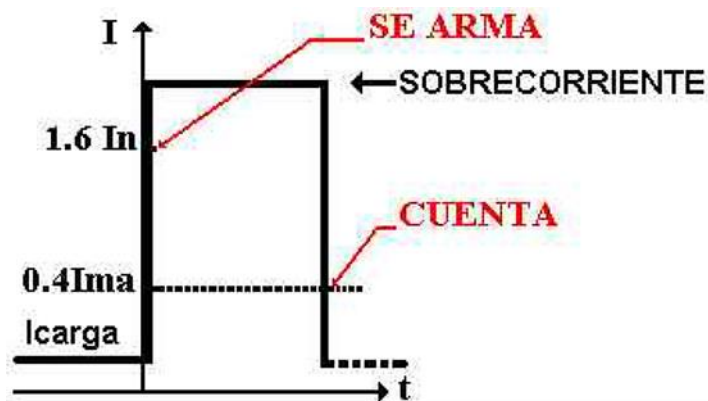
Figura N° 9: Operación de Conteo de un Seccionalizador
