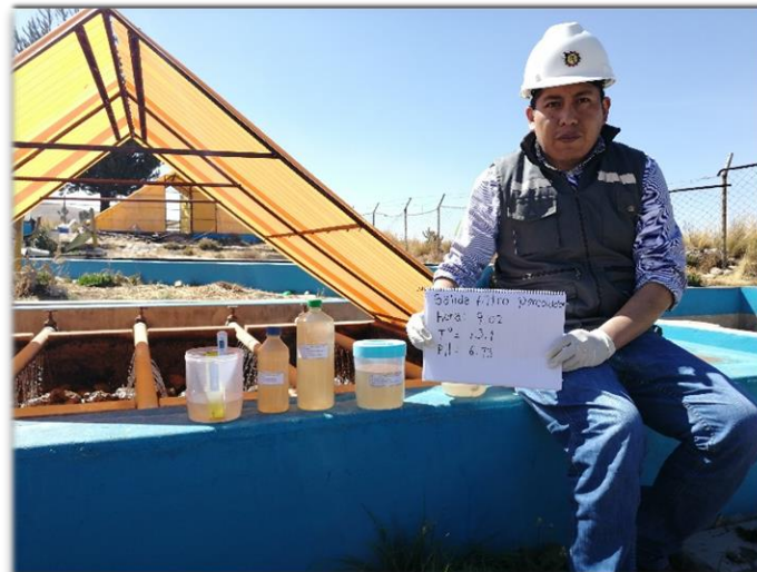
Figura A21. Toma de muestras a la salida del filtro percolador
