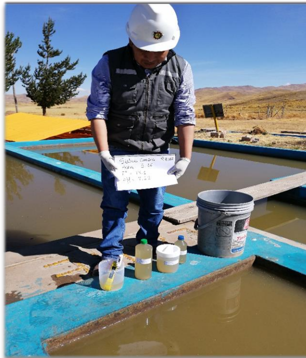
Figura A15. Toma de muestras a la salida de la cámara de rejas
