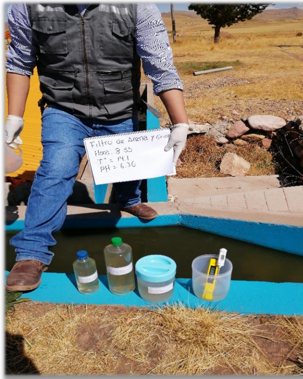
Figura A20. Toma de muestras en el ingreso a la cámara de rejas
