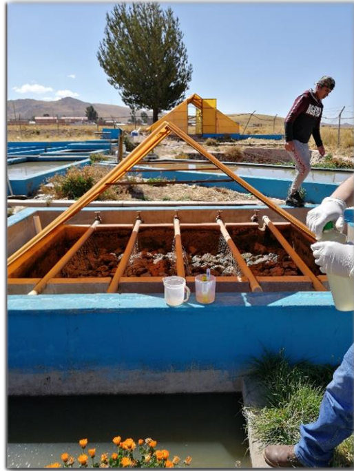
Figura A22. Toma de muestras a la salida del filtro percolador
