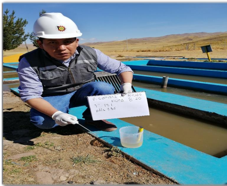
Figura A13. Medición del pH en campo a la entrada de la cámara de rejillas
