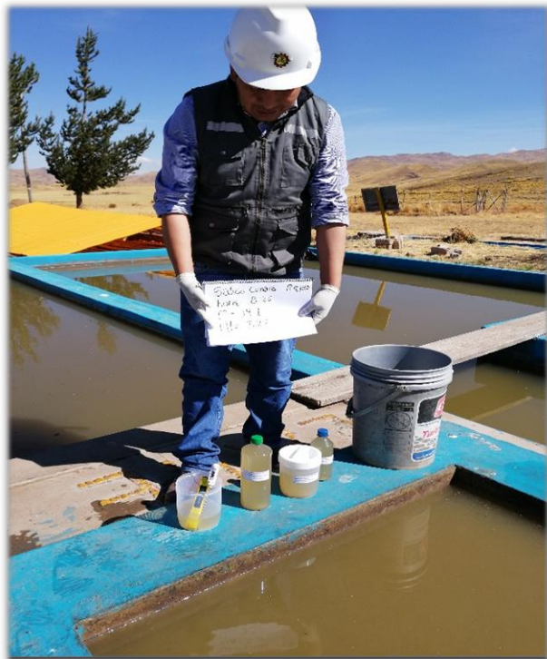
Figura 14. Toma de muestras en la salida de la cámara de rejas Fuente: Elaborado por el equipo de trabajo
