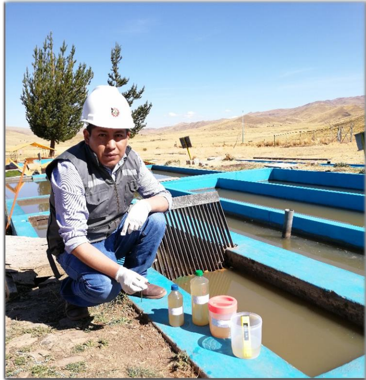
Figura A14. Toma de muestras a la entrada de la cámara de rejas
