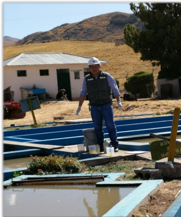
Figura 12. Toma de muestras en la salida del sedimentador 1 Fuente: Elaborado por el equipo de trabajo
