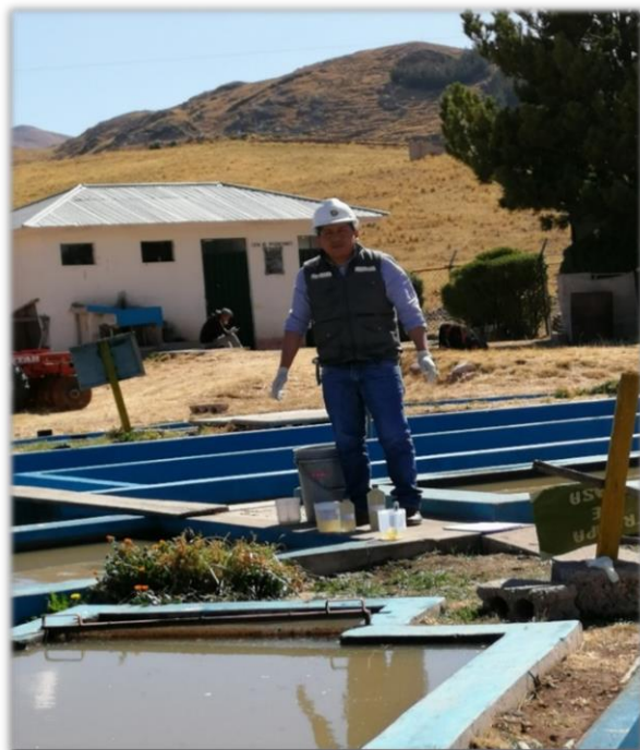
Figura A17. Toma de muestras a la salida de la trampa de grasas
