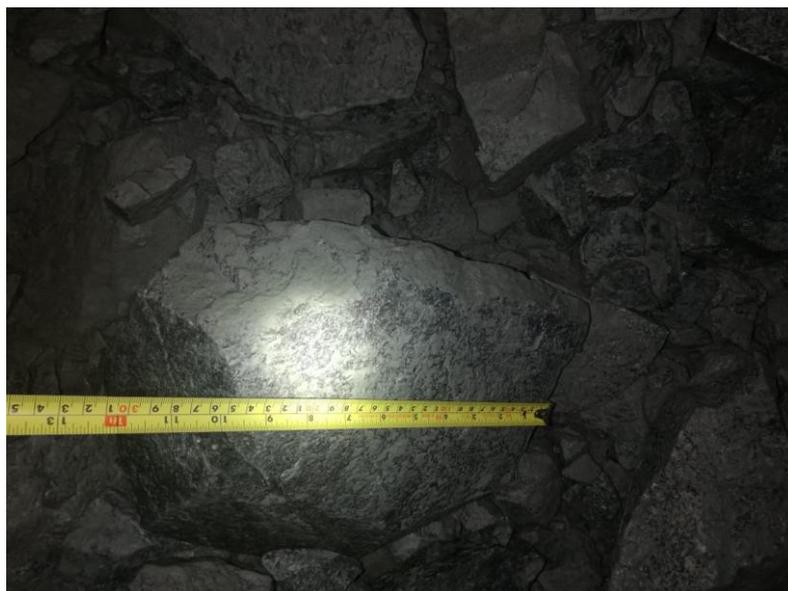
**Ilustración 4:** Vista de la voladura anterior, con fragmentos mayores a 8 pulgadas
