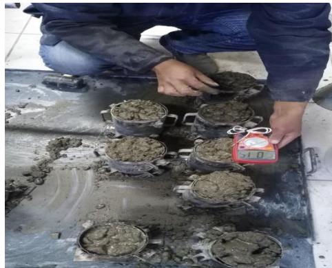
Figura 13. temperatura del concreto fresco
