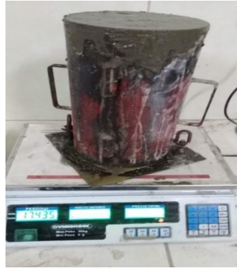
Figura 14. peso unitario y rendimiento de la mezcla de concreto fresco
