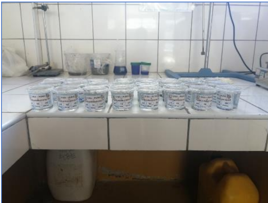
Figura 33: Preparación de los envases para la adición del carbón activado
