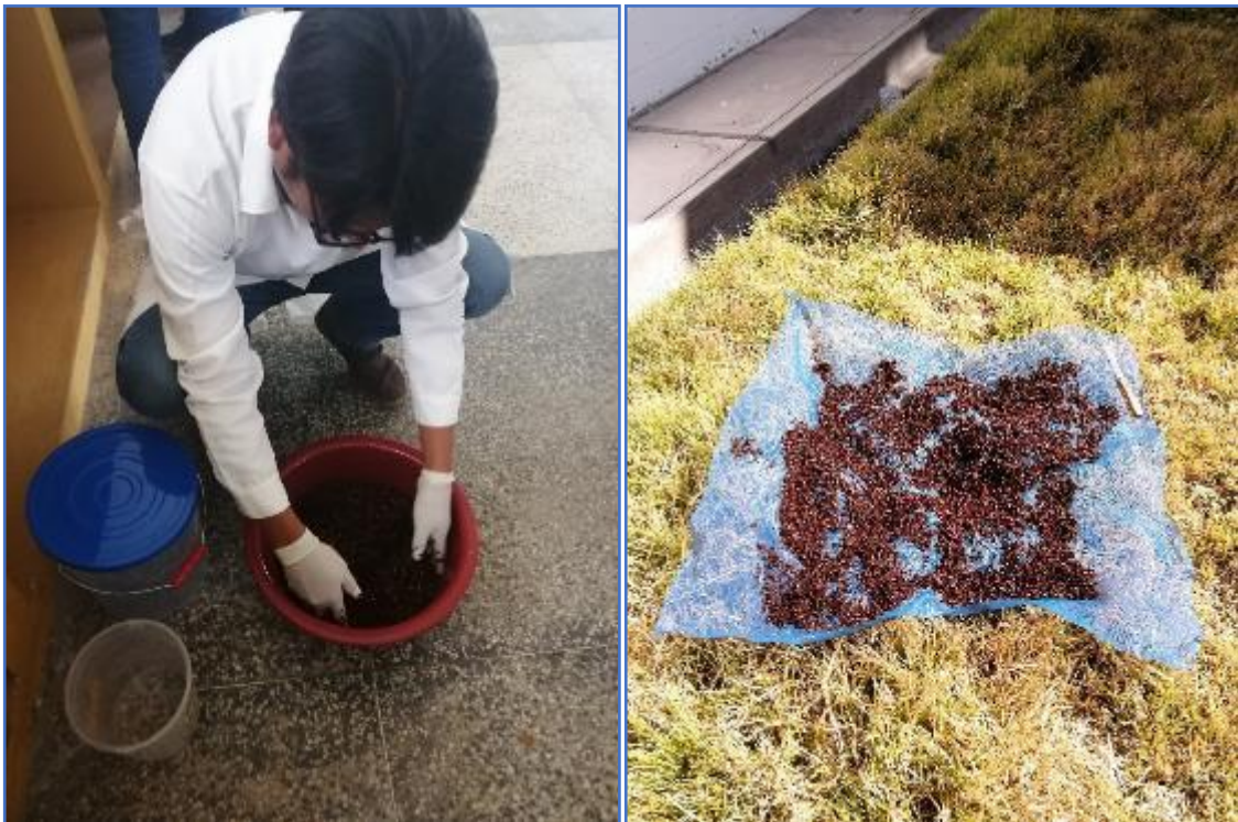
Figura 20: Activación con Ácido Fosfórico ( H_3PO_4 ) y secado
