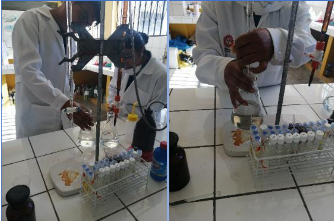
Figura 38. Medición de la muestra del parámetro de oxígeno Disuelto por titulación
