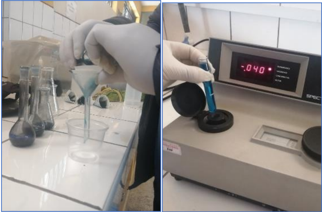
Figura 27: filtrado de la muestra de azul de metileno y lectura de la absorción
