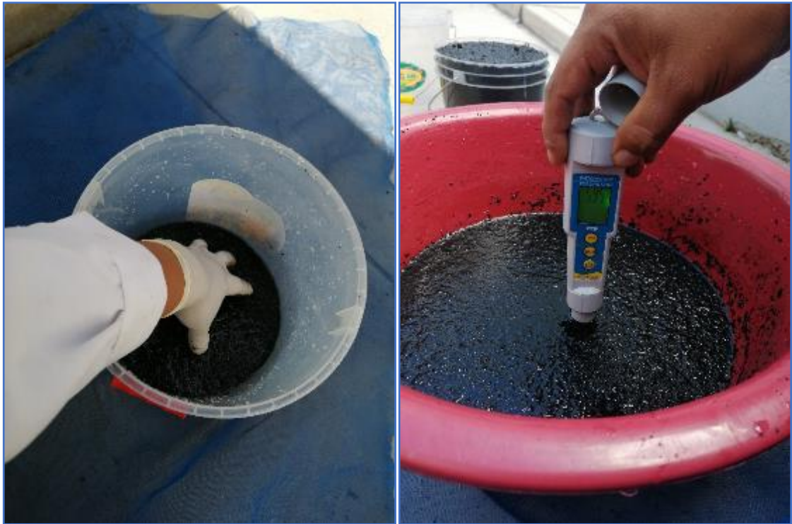
Figura 23: Lavado con agua destilada del material carbonizado a un pH de 5
