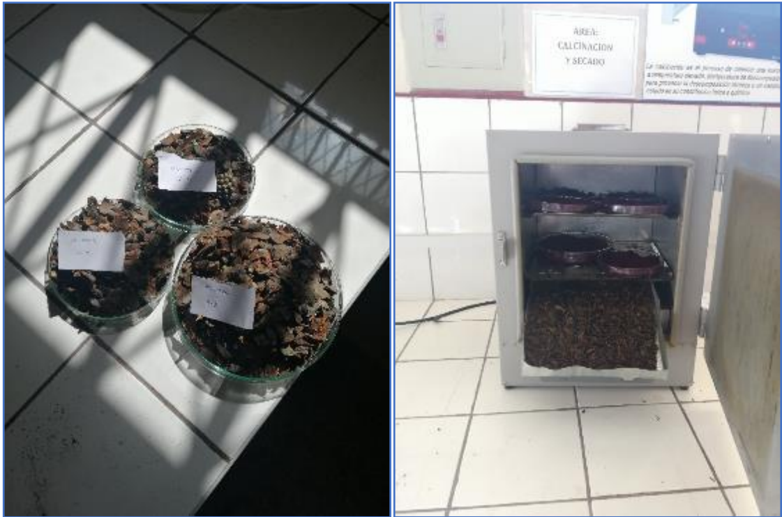
Figura 19: Contenido de humedad, secado a 110 °c +-5 por 24 horas
