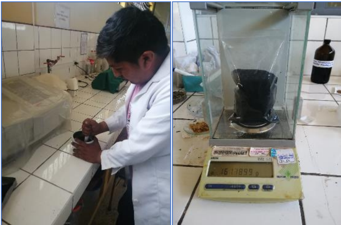
Figura 24: Molienda con mortero y almacenamiento del carbón activado
