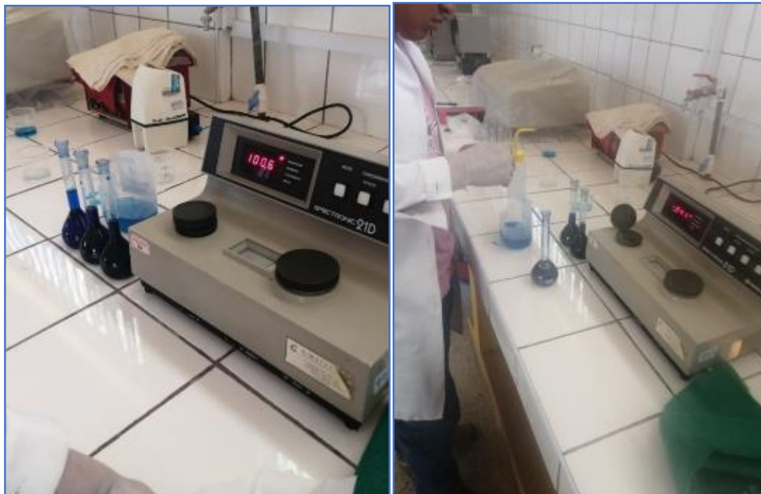
Figura 26: Lectura de la absorción a 453 nanómetros de onda de la dilución de azul de metileno
