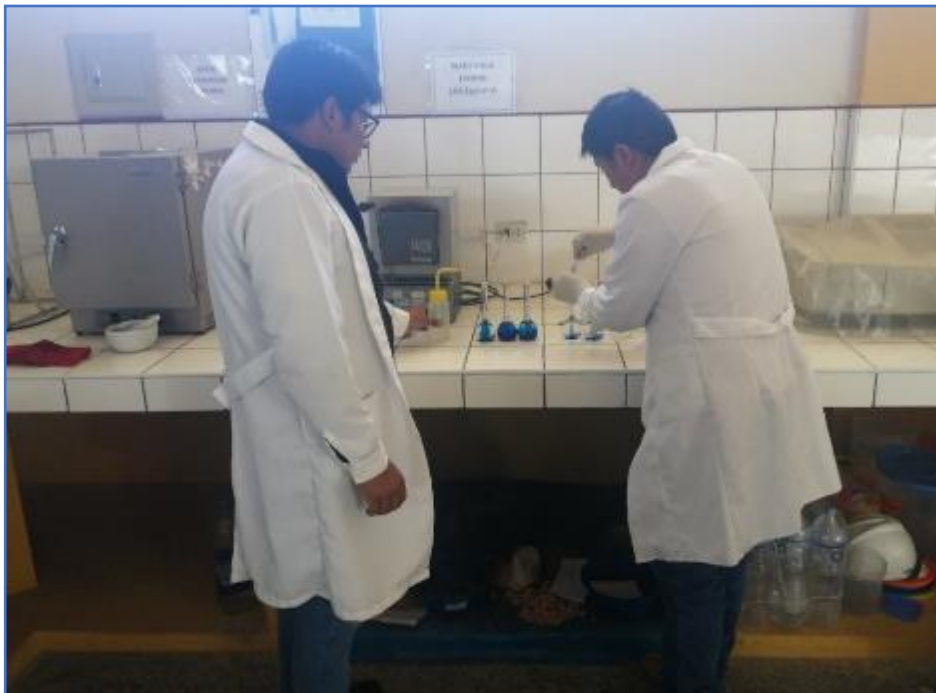
Figura 25: Dilución de azul de metileno de 50, 100, 200 mg. en 100 ml. de agua destilada.
