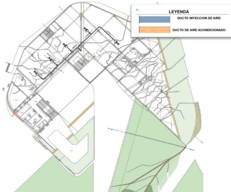
Imagen 116: Sistema de climatización - 1er Nivel. FUENTE: Elaborado por el equipo de trabajo.
