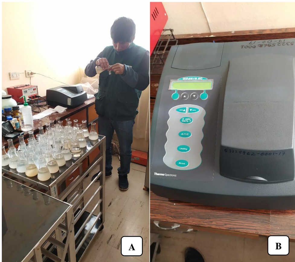
Figura 54. A: preparación de \text{SO}_4^{2-} , B: lectura de \text{SO}_4^{2-} en espectrofotómetro.
