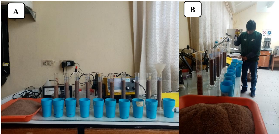
Figura 57. A: preparación de la D_{ap} método probeta, B: determinación de la D_{ap} .
