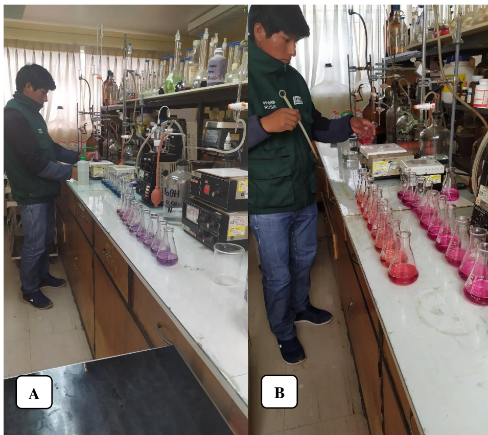
Figura 52. A: titulación de \text{Ca}^{++} más \text{Mg}^{++} , B: titulación de \text{Ca}^{++} .
