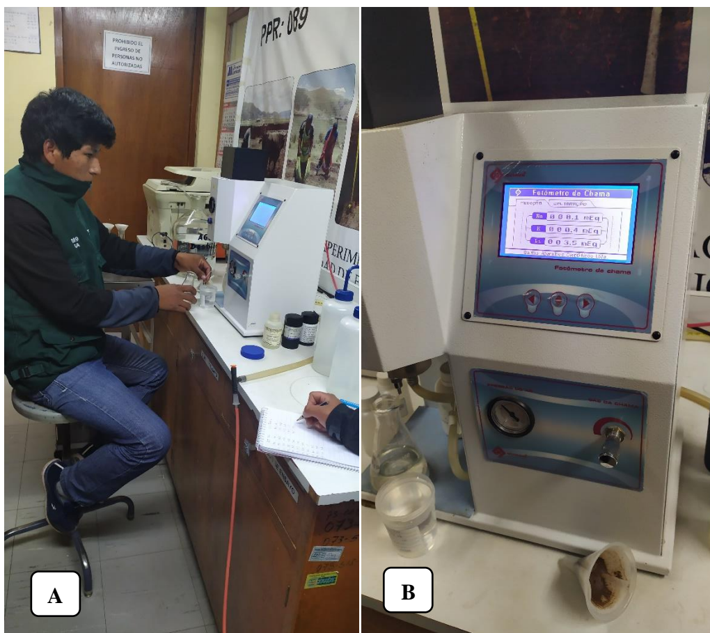
Figura 56. A: lectura de \text{Na}^+ y \text{K}^+ , B: fotometría de llama.
