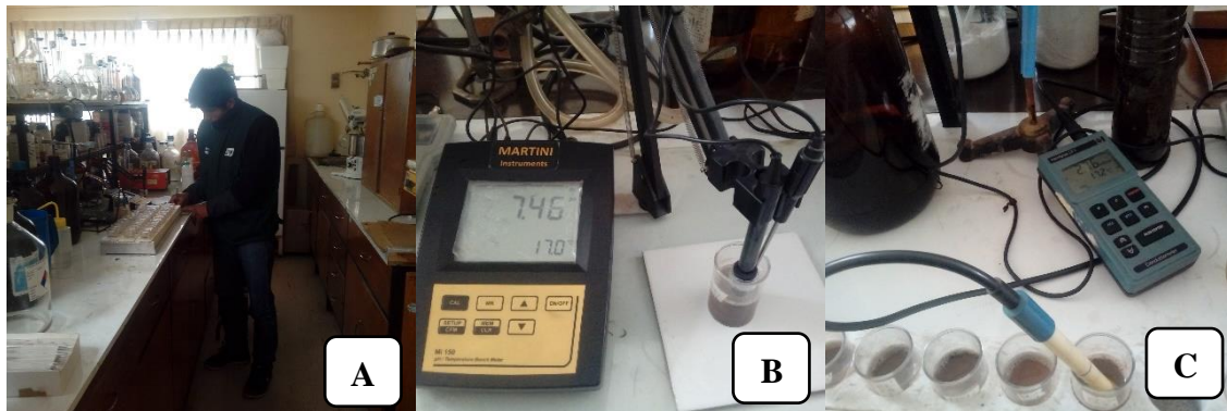
Figura 47. A y B: lectura de pH del suelo; A y C: lectura de la CE 1:25 del suelo.
