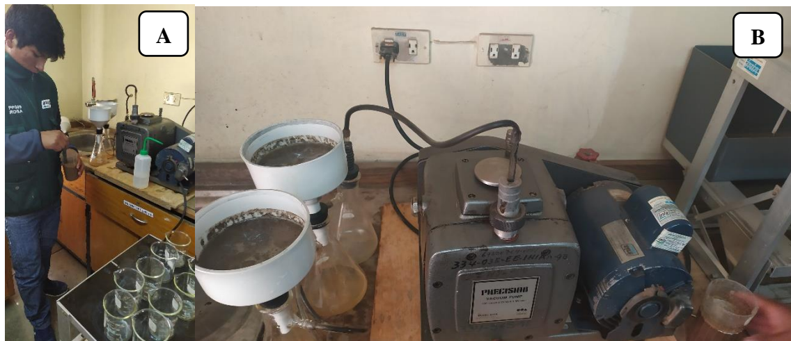
Figura 49. A: preparación de pasta de saturación, B: filtro del extracto de pasta de saturación en bomba de vacío.
