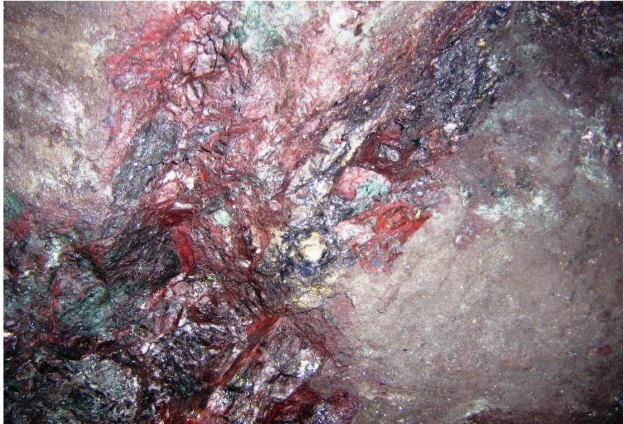
Figura 33. Emplazamiento de mineral de Pb y Zn de la veta Úrsula en una autobrecha andesítica, Nótese la abundante specularita y hematita.
