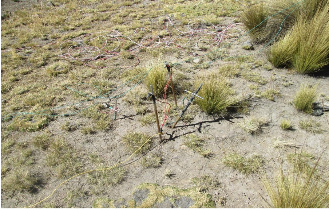
Figura 19. Tendido de cables y electrodos.
