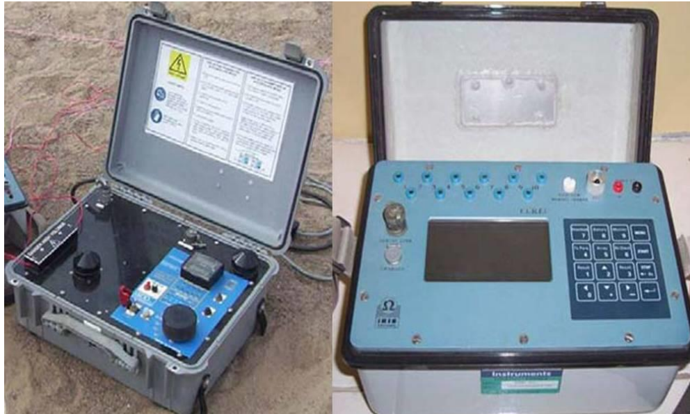
Figura 21. Equipos de adquisición y transmisión empleados (transmisor GDD y Receptor Iris ELRec Pro)
