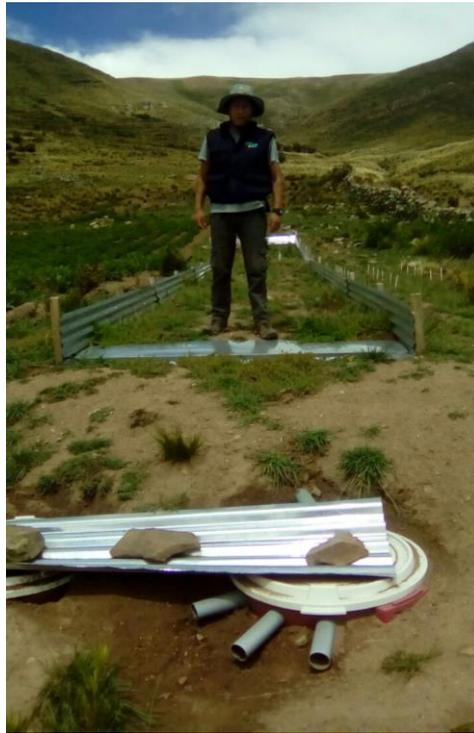
**Anexo 31.** Vaciado de los cilindros colectores de las parcelas de esorrentía para un nuevo registro de datos.
