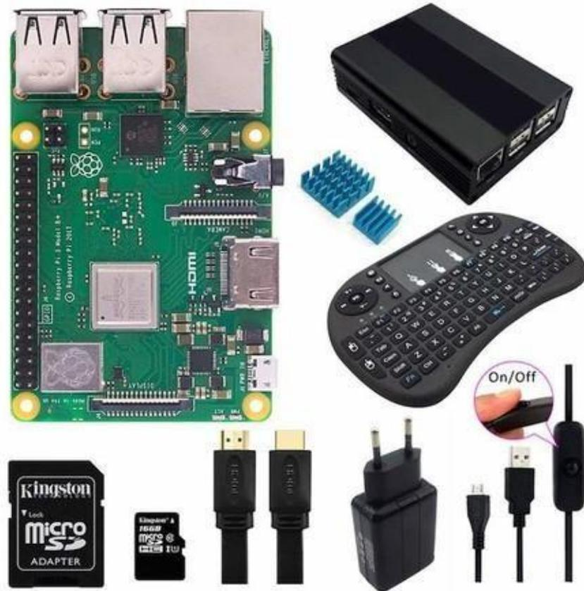
**Figura N° 3** Accesorios del Raspberry Pi
