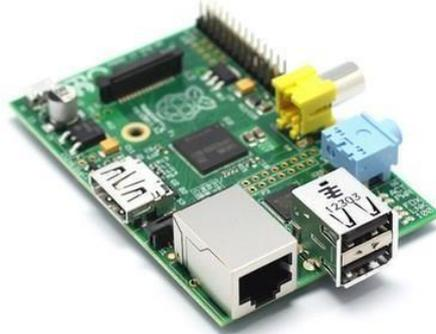
**Figura N° 2** Mainboard Raspberry Pi
