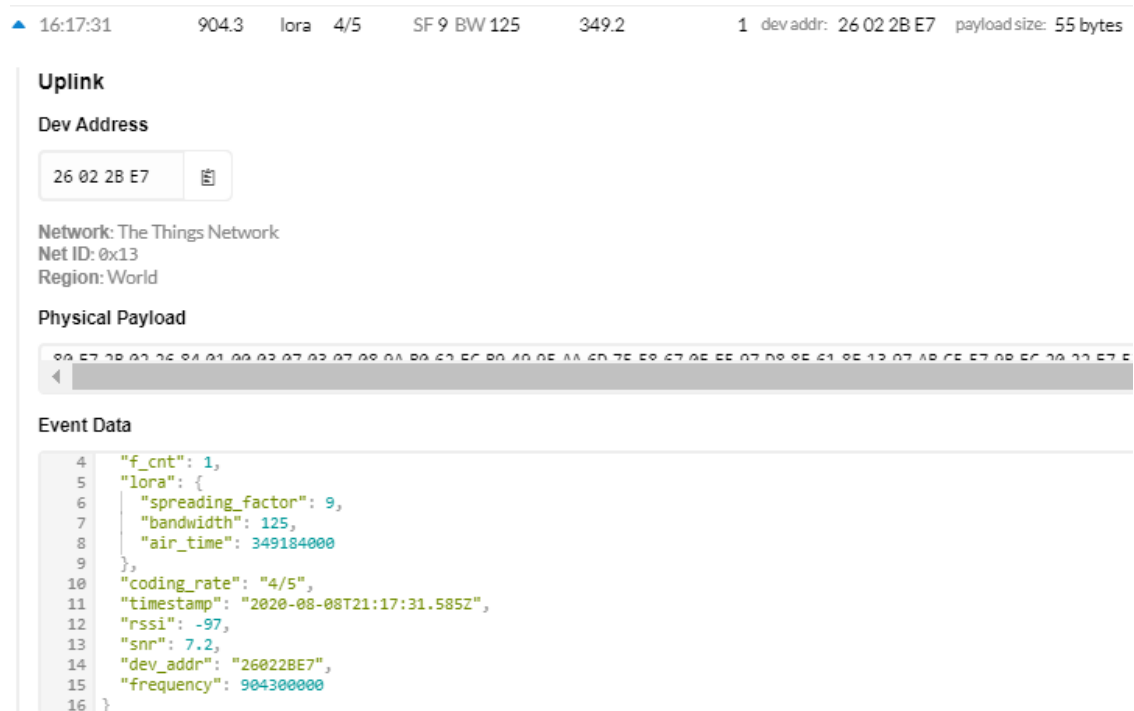
Figura 41. Trama de información que pasa por el Gateway, a partir del End Node hacia TTN, parte 1.
